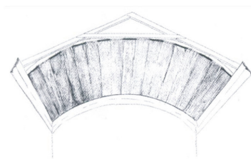
Forro de abóbada
