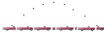
Um objeto é jogado para cima, a partir de um carro em movimento.
