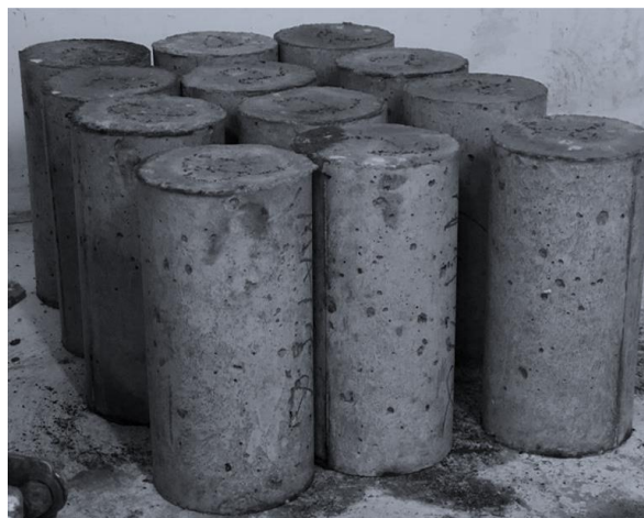
Figura 42-Concreto de maior resistência dosado para obtenção dos parâmetros p e q.
