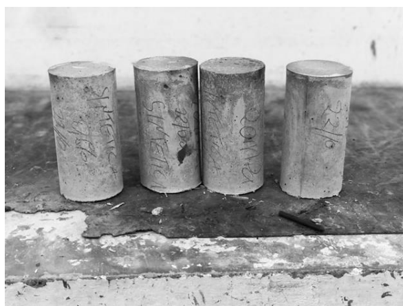
Figura 64-Amostras cilíndricas de 10 x 20 cm utilizados nos ensaios de resistência à compressão.
