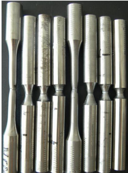
a) CPs cilíndricos após a fratura b) CPs retangulares após fratura
