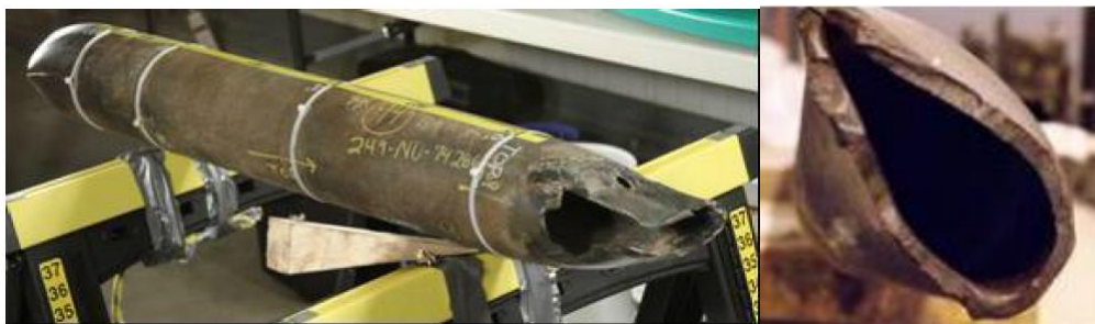
c) Riser rígido após o acionamento da BOP
