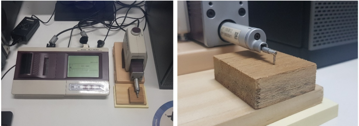
Figura 9. Ensaio de rugosidade superficial realizado com o equipamento Rugosímetro Surftest modelo SJ - 400 ( Mitutoyo ). Foto: o autor.
