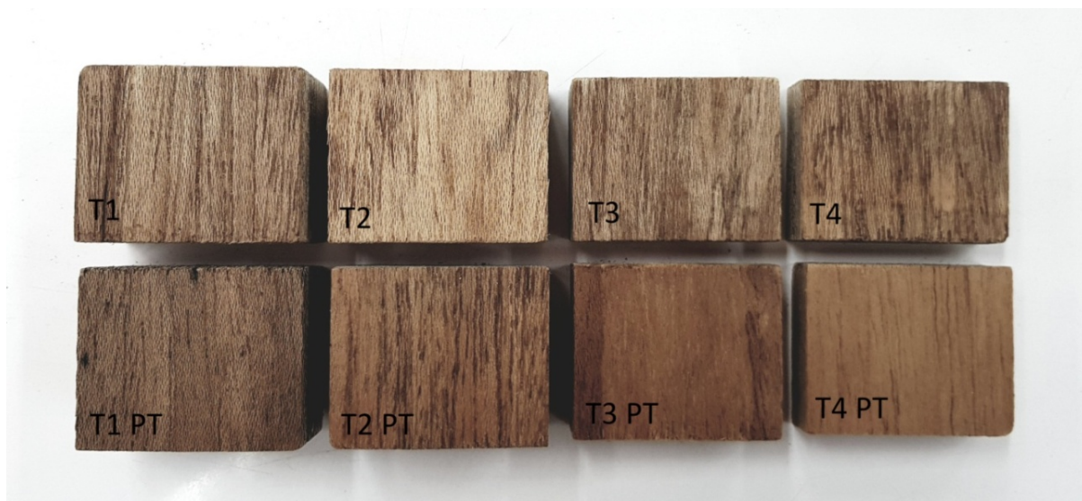
Figura 20. Amostras termodensificadas comparadas às amostras termodensificadas que receberam o pós-tratamento térmico. T1: tratamento 1; T2: tratamento 2; T3: tratamento 3; T4: tratamento 4; T1 PT: tratamento 1 após o pós-tratamento térmico; T2 PT: tratamento 2 após o pós-tratamento térmico; T3 PT: tratamento 3 após o pós-tratamento térmico; T4 PT: tratamento 4 após o pós-tratamento térmico.
