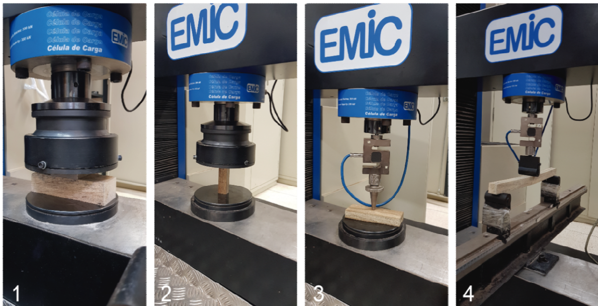
Figura 6. 1: ensaio de resistência à compressão perpendicular às fibras; 2: ensaio de resistência a compressão paralela às fibras; 3: ensaio de dureza janka superficial; 4: ensaio de flexão estática. Foto: o autor.
