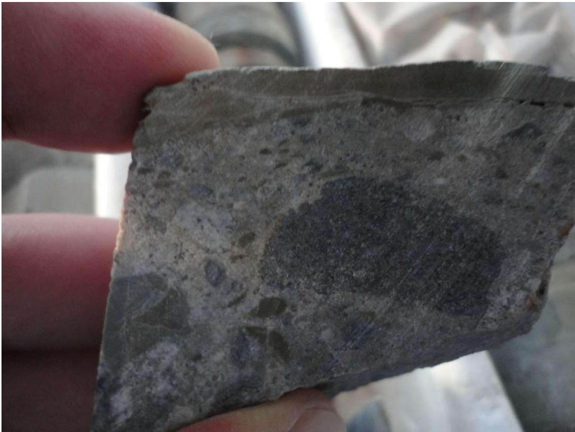
Figura 4.1.3-Diamictito da Formação Jequitai do testemunho de sondagem 1-PSB-13-MG. Notar a discordância erosiva no topo da amostra e o dololulito da base da Formação Sete Lagoas.
