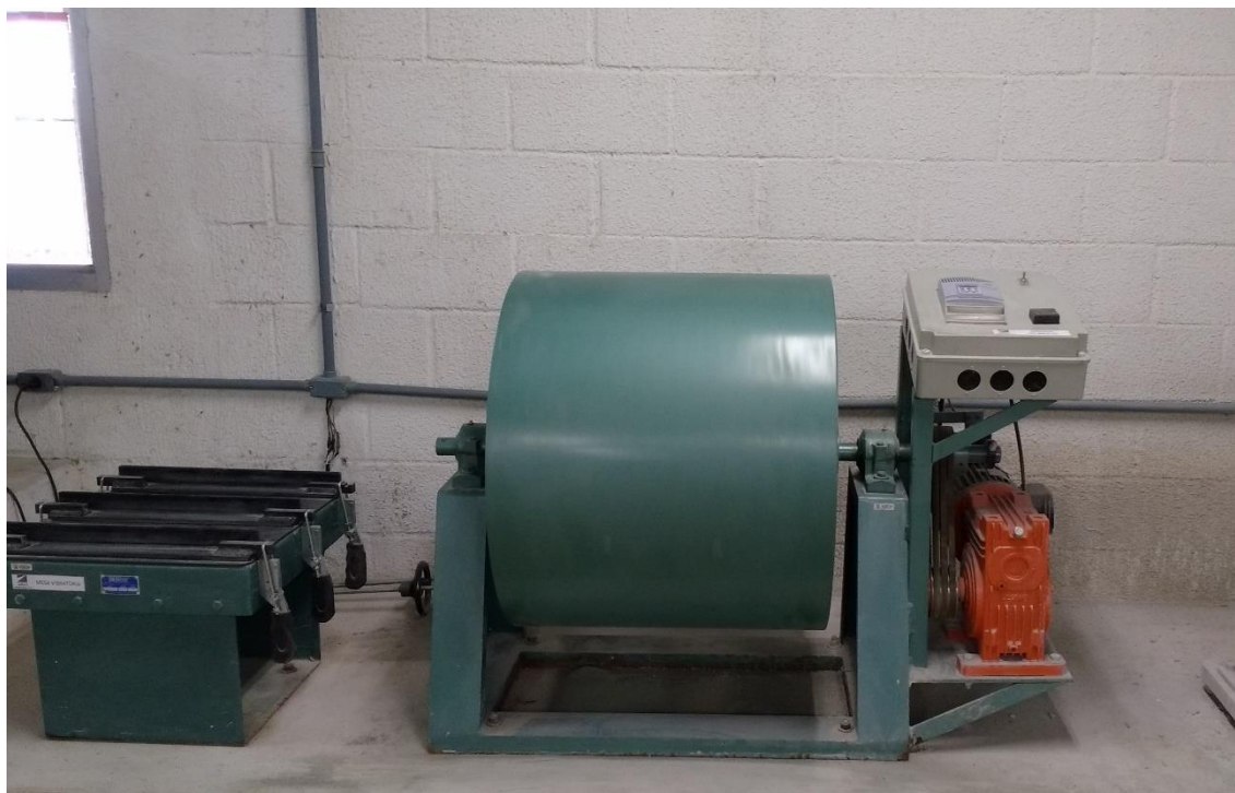
Figura 4.3 – Equipamento de abrasão Los Angeles adaptado para moagem de clínquer e gipsita (foto do autor)
