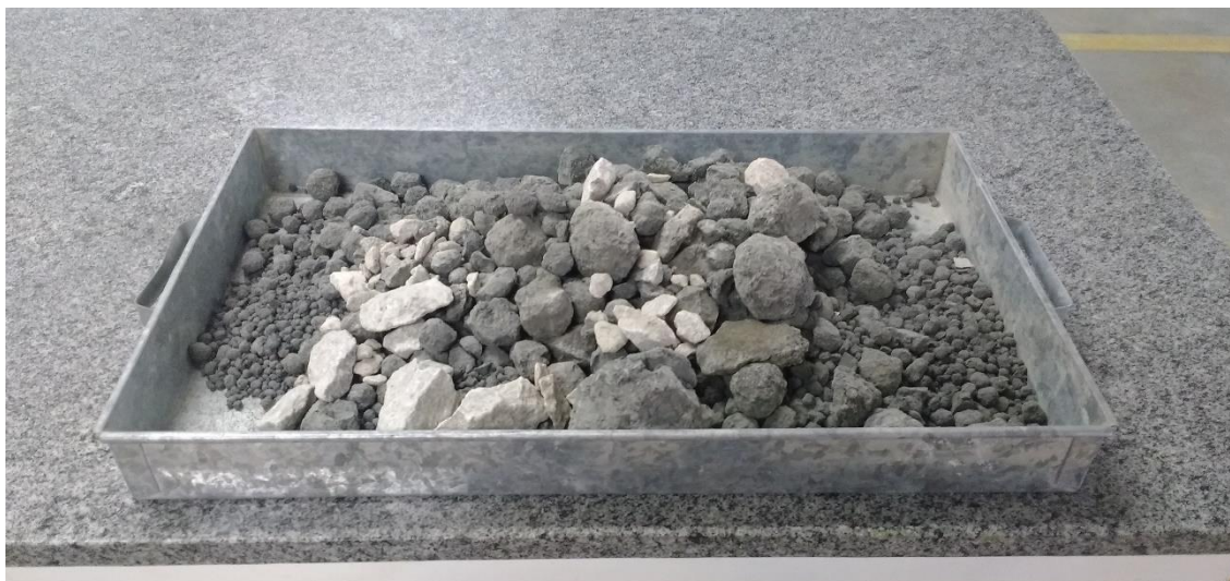
Figura 4.4 – Clínquer e gipsita in natura aguardando moagem
