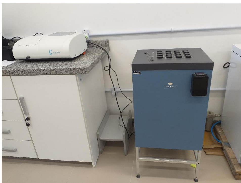
Figura 4.7 - Calorímetro de condução utilizado neste ensaio.
