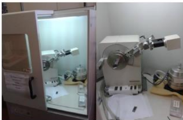
Figura 4.2 – Difratômetro de Raios X utilizado na pesquisa
