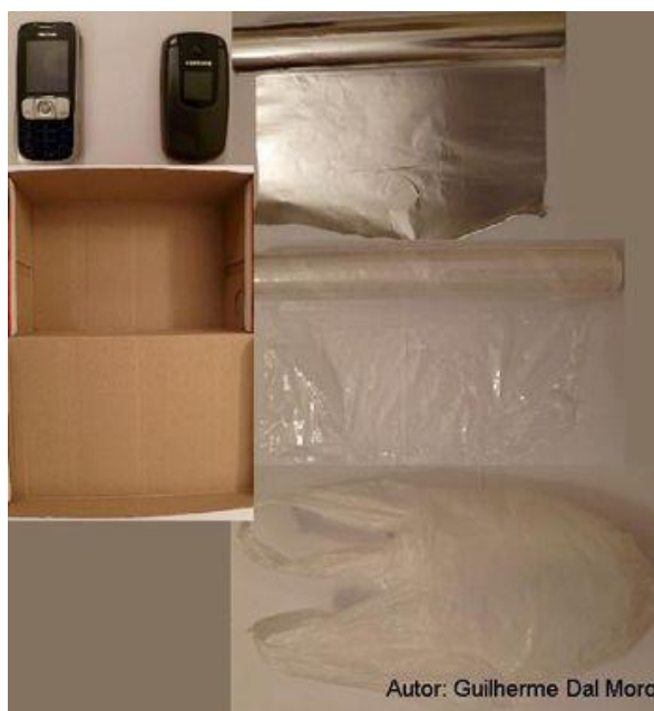
Figura 14: Preparação do experimento: blindagem de um celular.
