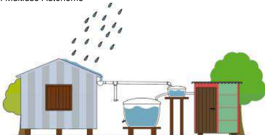
Figura 1. Esquema da captação da água de chuva no telhado da moradia em um Sistema Pluvial Multiuso Autônomo
