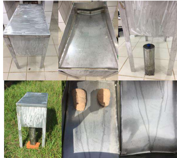
Figura 3: Caixa extratora de óleo - produção Fitorixi + UFOPA
