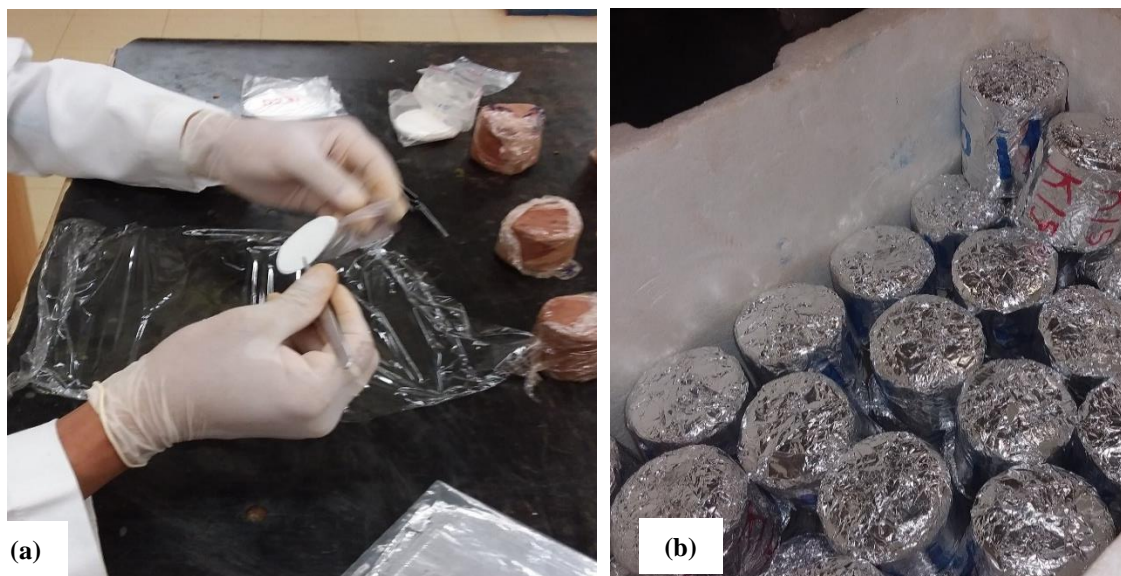
Figura 4-19 – Determinação da sucção: (a) preparação; (b) condição de armazenamento
