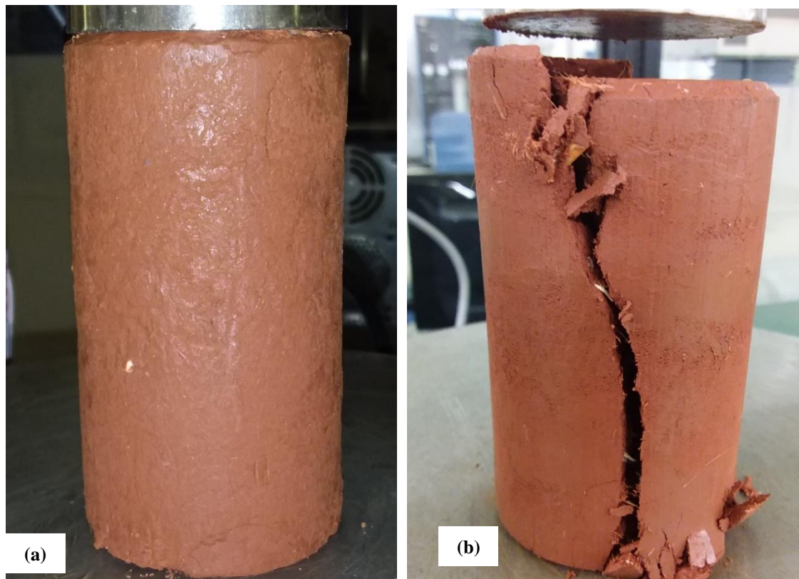
Figura 4-21 – Resistência à compressão simples: montagem do ensaio durante (a) e após (b) ruptura
