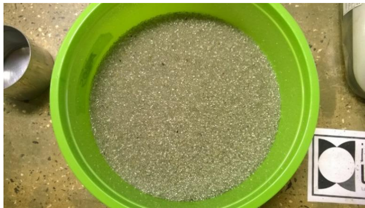
Figura 4.1 - Esferas de vidro Potters, tipo A-072
