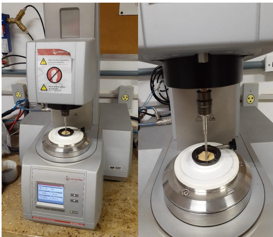
Figura 4.6 - Reômetro Anton Paar utilizado para o ensaio de mini palheta
