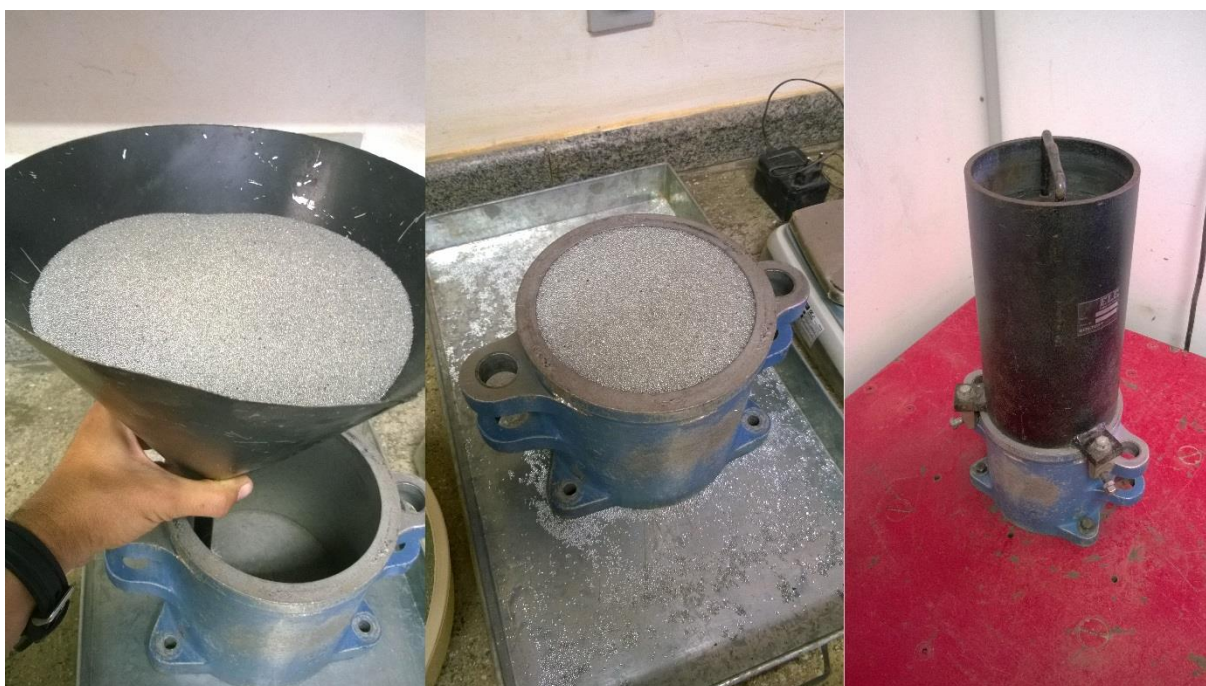
Figura 4.3 - Procedimentos dos ensaios de índice de vazios máximo e mínimo
