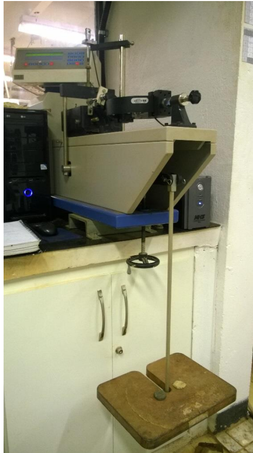
Figura 4.4 - Equipamento utilizado para o ensaio de cisalhamento direto
