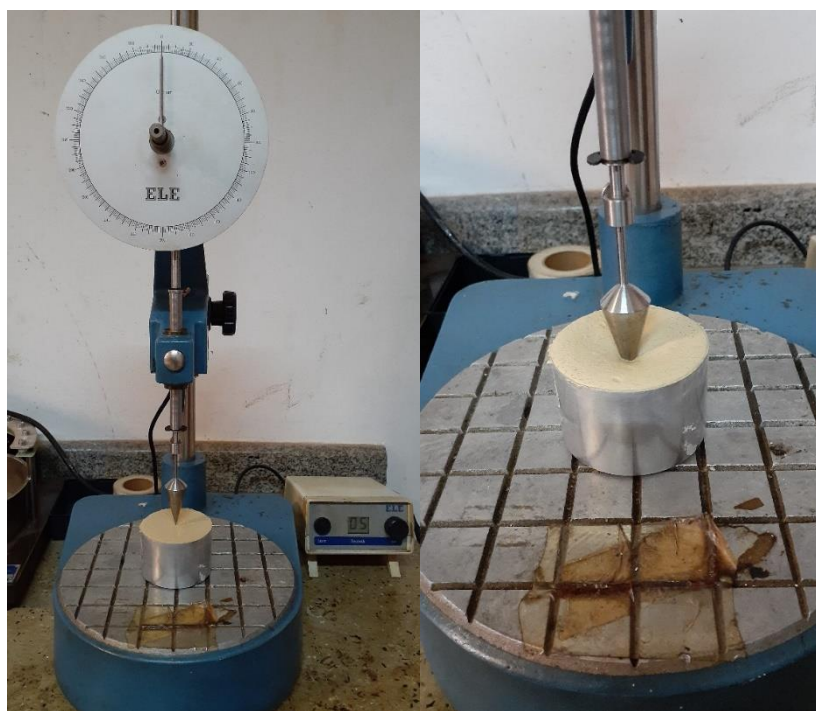
Figura 4.5 – Equipamentos utilizados no ensaio de penetração de cone
