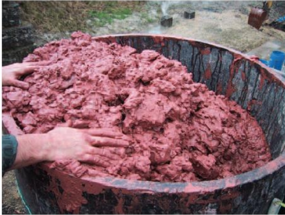
Figura 2.9 - Mistura homogênea entre rejeito e estéril (Wilson et al. , 2003).
