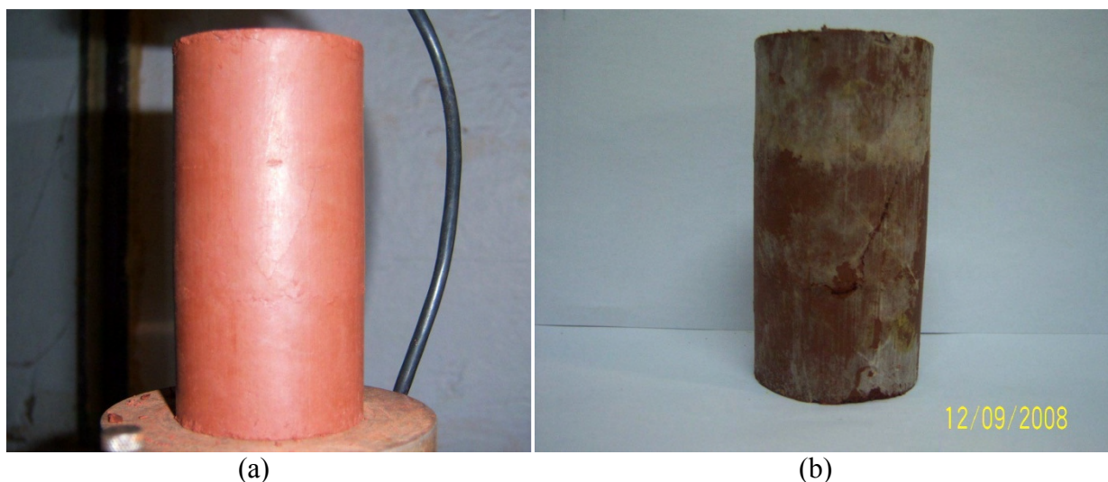
Figura 4.26 Falhas dos corpos de prova em compressão simples (a) SNIO (b) B4IO
