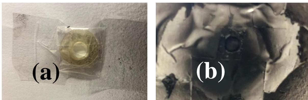
Figura 3.10. Eletrólito posicionado no molde antes (a) e depois (b) da deposição do suporte poroso
