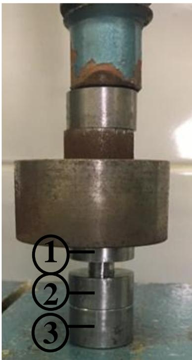
Figura 3.3. Prensagem do material Z10-Pch
