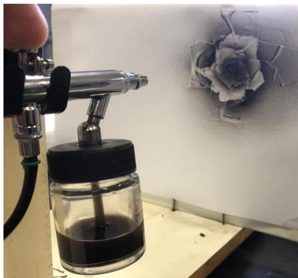
Figura 3.9. Deposição da mistura *slurry* no eletrólito
