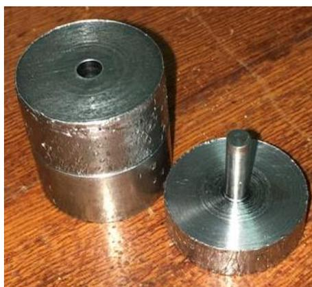
Figura 3.6. Moldes metálicos para prensagem de corpo de prova de 4 mm de diâmetro
