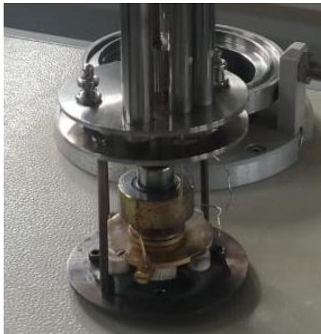
Figura 3.19. Dispositivo para colocar amostra metalizada para EIS
