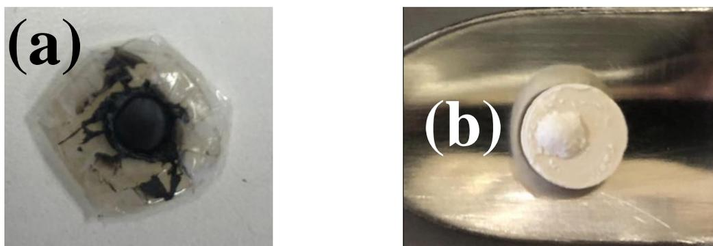
Figura 3.11. Eletrólito com suporte poroso depositado antes (a) e depois (b) do tratamento térmico a 1500 °C
