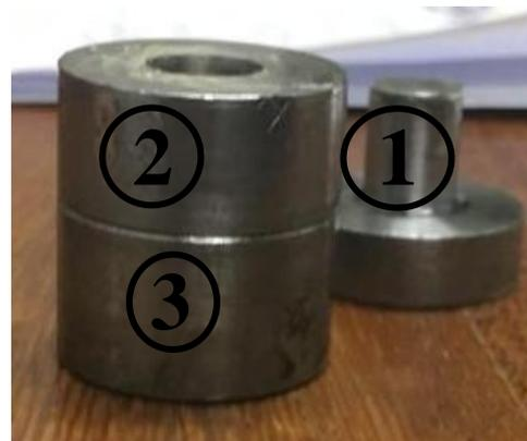
Figura 3.4. Moldes metálicos para prensagem de eletrólito de 1 cm de diâmetro
