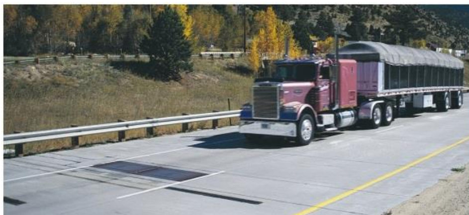
Figura 4.3: Sensor do tipo balança baseada no uso de células de carga Fonte: Al-Qadi et al. (2016)
