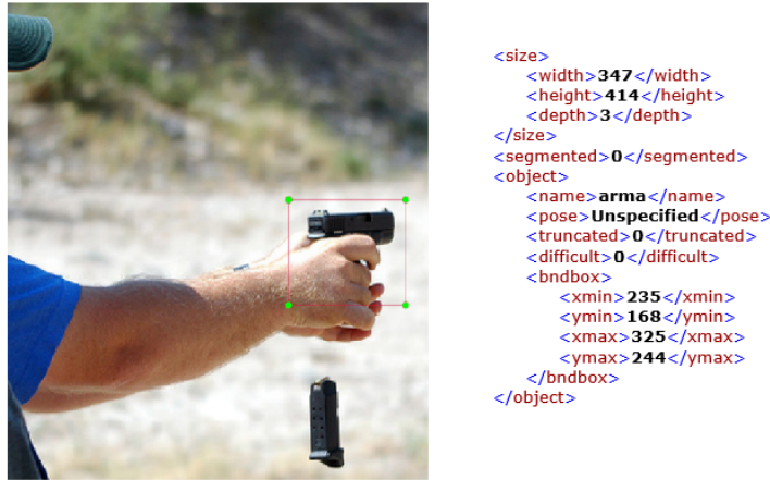
Figura 3.4: Exemplo de anotação de um objeto de interesse e fragmento do arquivo xml gerado.
