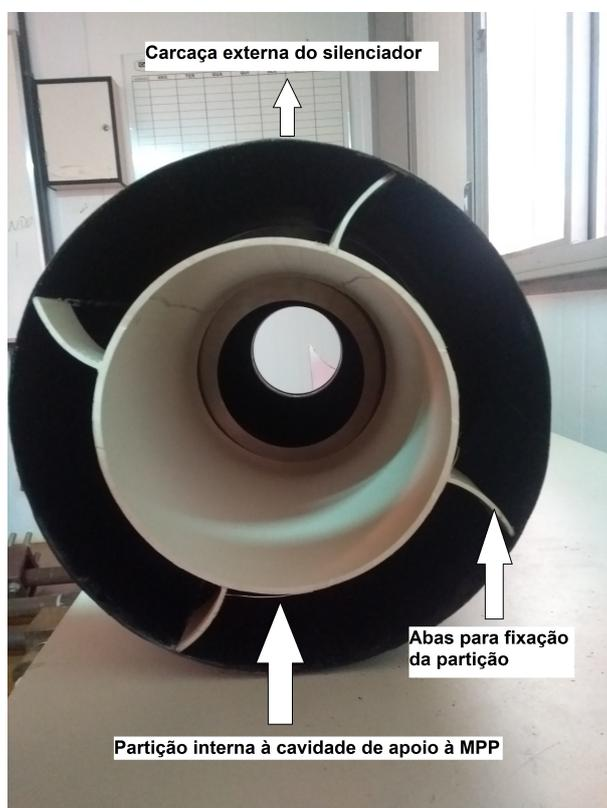
Figura 7.17 – Detalhe da partição interna inserida na cavidade de apoio à MPP.
