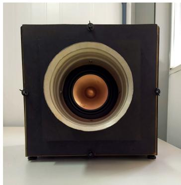
Figura 6.4 – Fonte Sonora utilizada na bancada de testes: alto-falante embutido na caixa acústica.
