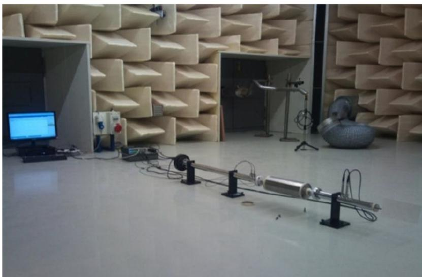
Figura 2.8 – Set up experimental para medição da TL de câmara de expansão em uma sala anecóica. Fonte: [Rajadurai, Raj e Mathan \(2015\)](#).
