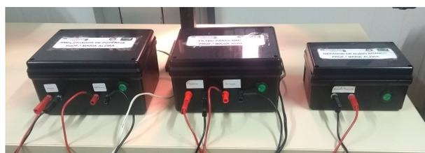
Figura 6.5 – Equipamentos utilizados para fornecimento do sinal de teste ao alto-falante.
