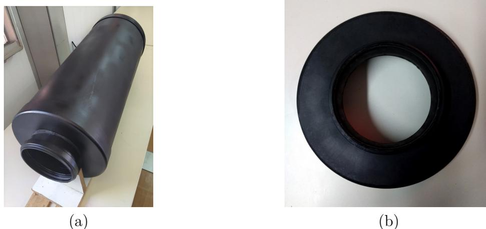
Figura 6.8 – Objeto de teste da bancada experimental. (a) Silenciador e (b) Detalhe da adaptação existente na entrada e na saída do silenciador.
