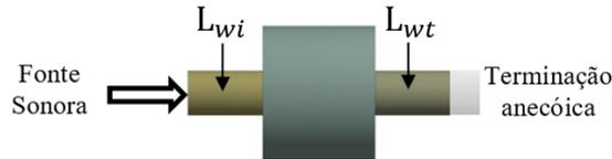
Figura 3.2 – Esquema para obtenção da TL de uma câmara de expansão simples.
