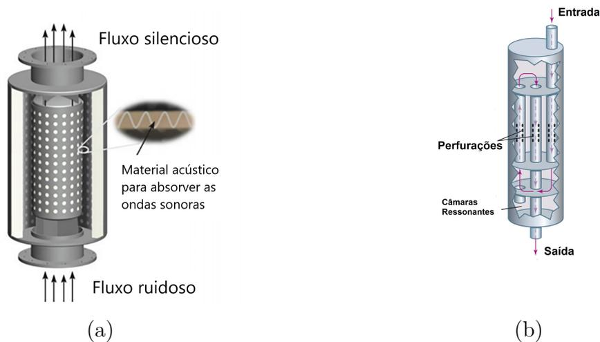
Figura 1.3 – Filtros acústicos: (a) Dissipativo. Fonte: Controls (2019); (b) Reativo. Fonte: Encyclopaedia Britannica (2008).
