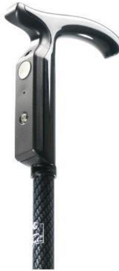
Figura 2.2 - Bengala inteligente. Esse dispositivo é embasado em Inteligência Artificial e possui um detector de queda embutido na bengala. Fonte: Dring (2020)
