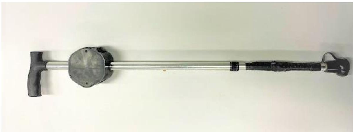
**Figura 3.1.** A Bengala Afetiva desenvolvida, que é composta por uma bengala de alumínio, ajustável, de ponto único, da marca Mercur, com um sistema embarcado (de cor preta) que foi embarcado em seu corpo.
