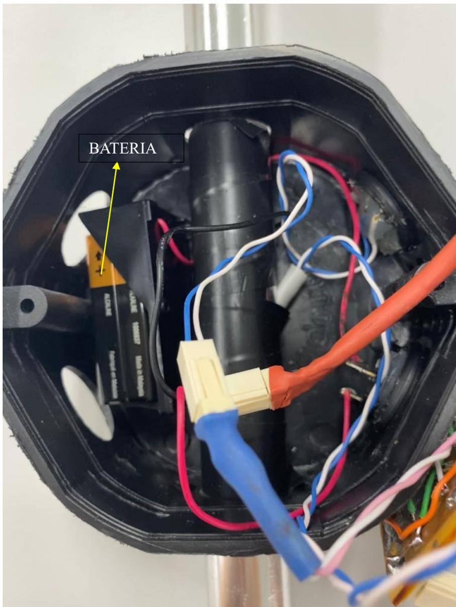
**Figura 3.3.** Alimentação do dispositivo – uma bateria simples é responsável pela alimentação do sistema.
