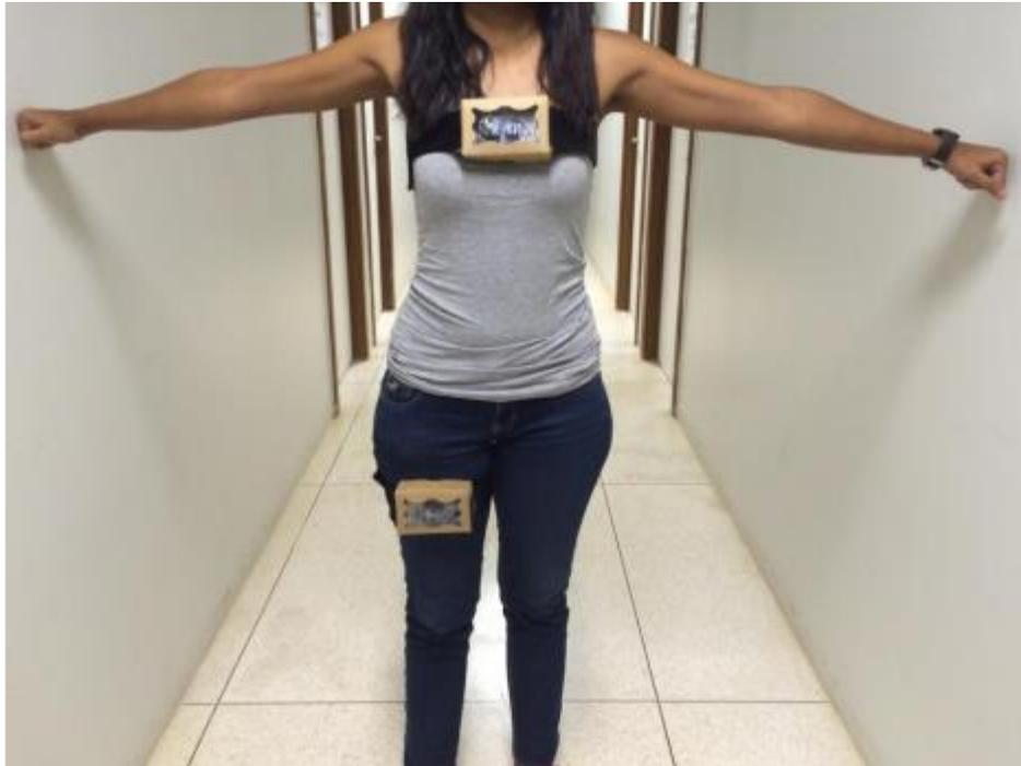
Figura 2.7 – Sistema de detecção de quedas e de posicionamento corporal com monitoramento de batimentos cardíacos. Fonte: Malheiros (2015).
