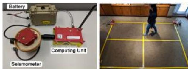
Figura 2.6 – Sistema Inteligente. Composto por um sismógrafo de três canais, uma placa de computador único e uma bateria de lítio, que fazem a detecção da vibração produzida pela queda. Fonte: Clemente et al. (2019).
