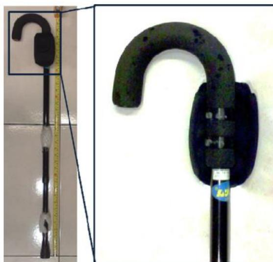
Figura 2.1 - Bengala com sistema embarcado inteligente. O sistema permite coletar os dados de aceleração da bengala em 3D. Fonte: Chen et al. (2015).
