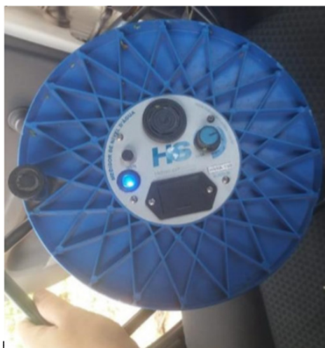
Figura 3. Painel eletrônico do medidor elétrico para nível de água.
