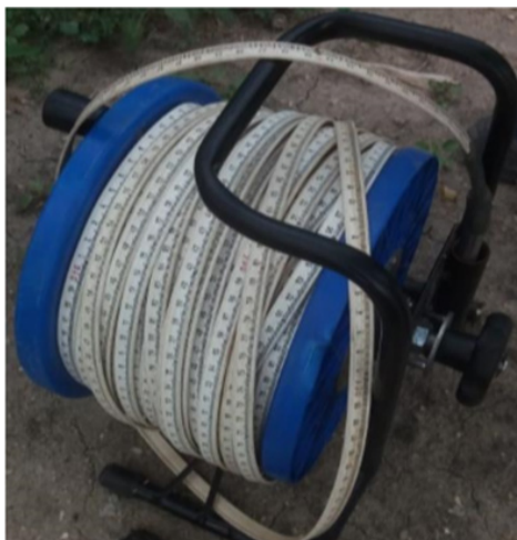
Figura 2. Medidor elétrico para nível de água.
