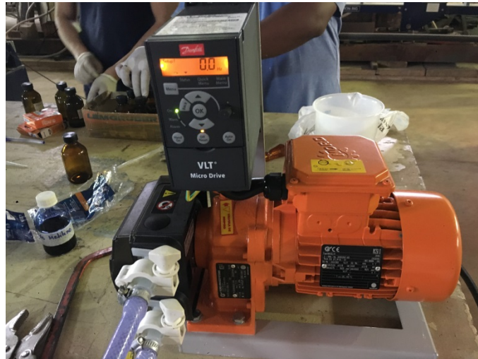
Figura 24 – Detalhe da bomba peristáltica utilizada no ensaio em laboratório.
