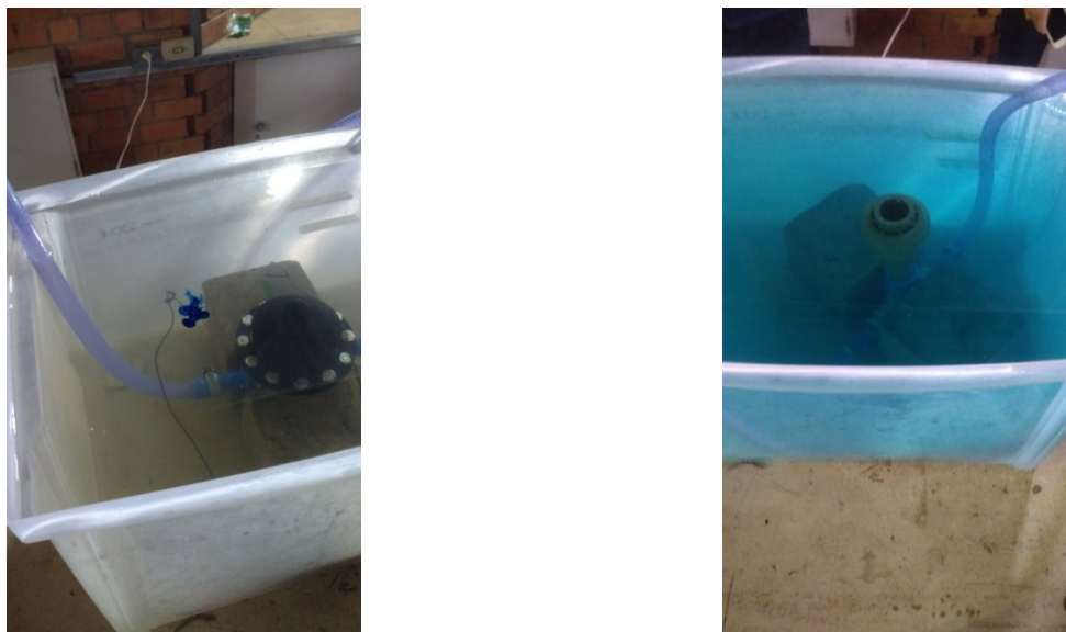
Figura 30 – Ensaio de contaminação do eliminador Dolphin e da válvula ventosa Tigre, respectivamente.
