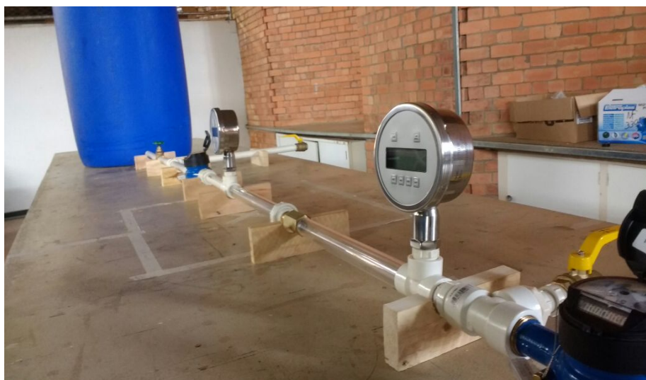
Figura 11 – Detalhe do tubo acrílico cristal entre os manômetros e o dispositivo de teste.
