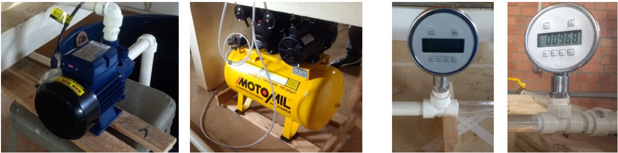
Figura 12 – Detalhe da bomba, do compressor e dos manômetros utilizados nos ensaios.
