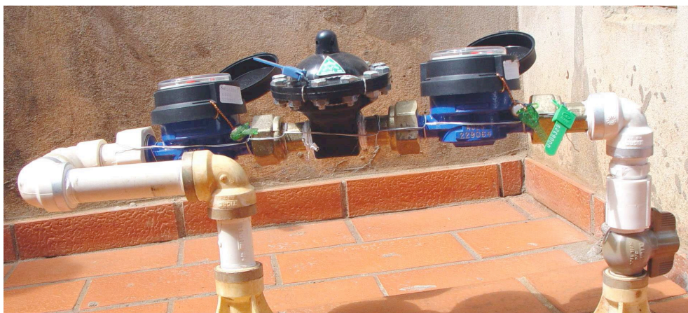
Figura 4 - Cavalete especial montado para verificação da influência do eliminador de ar na medição do consumo de água na rede de distribuição (Souza et al., 2006).
