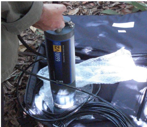
Figura 21 - a) Sonda multiparâmetros utilizada para obter os dados do monitoramento realizado pelo IBRAM. b) garrafa de polietileno utilizada para coleta das amostras que foram analisadas em laboratório.
