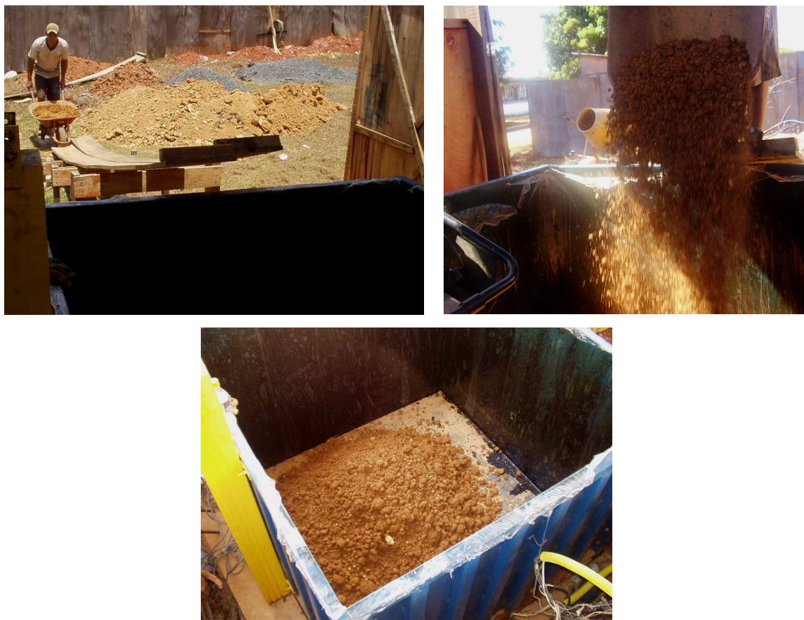
Figura 5.5 – Disposição do solo no interior da caixa de ensaio
