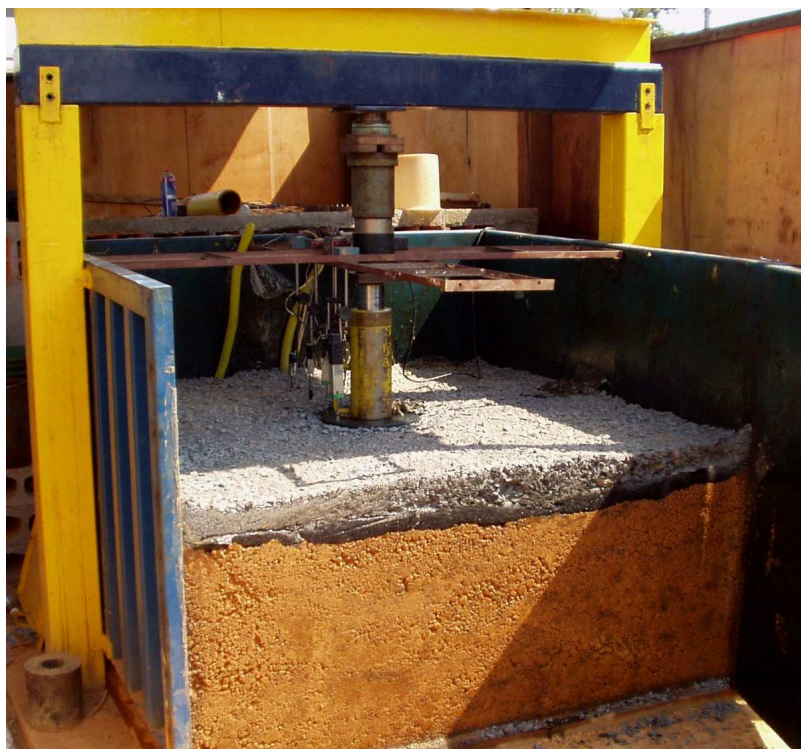
Figura 4.2 Caixa de Ensaio e Sistema de Reação – Vista com a face lateral aberta
