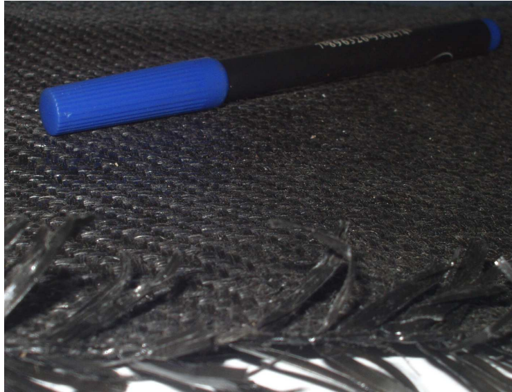
Figura 3.2 – Geotêxtil tecido utilizado no presente trabalho.
