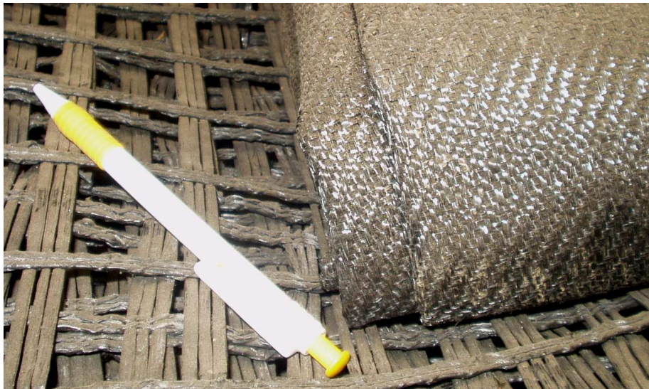
Figura 3.3 – Ilustração dos dois materiais utilizados: geogrelha e geotêxtil tecido.
