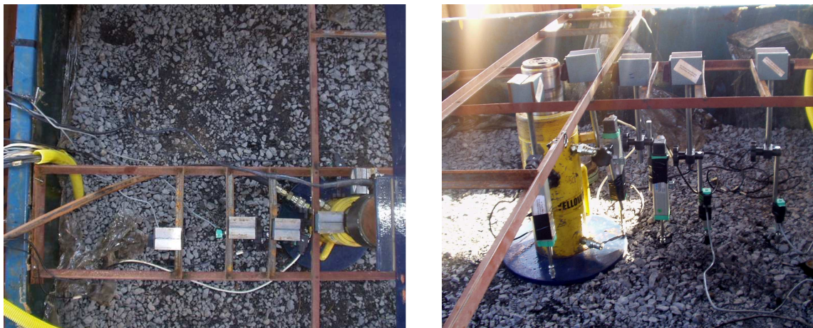
Figura 5.18 – Posicionamento dos LVDT's no interior da caixa de ensaio (vista superior e vista lateral).
