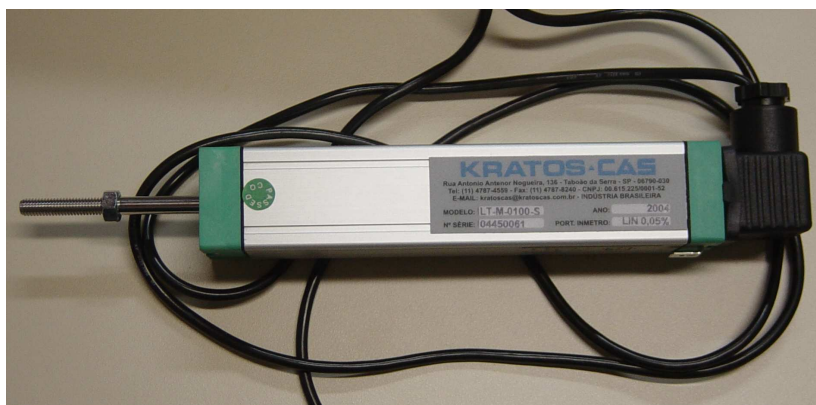
Figura 4.7 – LVDT utilizado nos ensaios para medição de deslocamentos superficiais.
