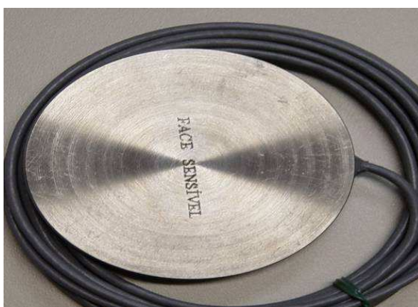
Figura 4.8 – Célula de tensão total utilizada no ensaio
