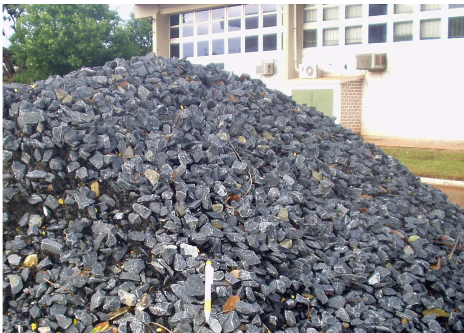
Figura 3.6 – Brita graduada simples utilizada nos ensaios.
