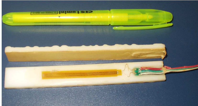
Figura 4.9 – Extensômetro elétrico utilizado no ensaio.
