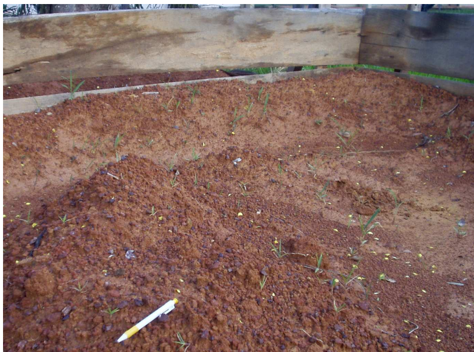
Figura 3.4 – Solo fino utilizado como subleito, acondicionado em silo próprio.
