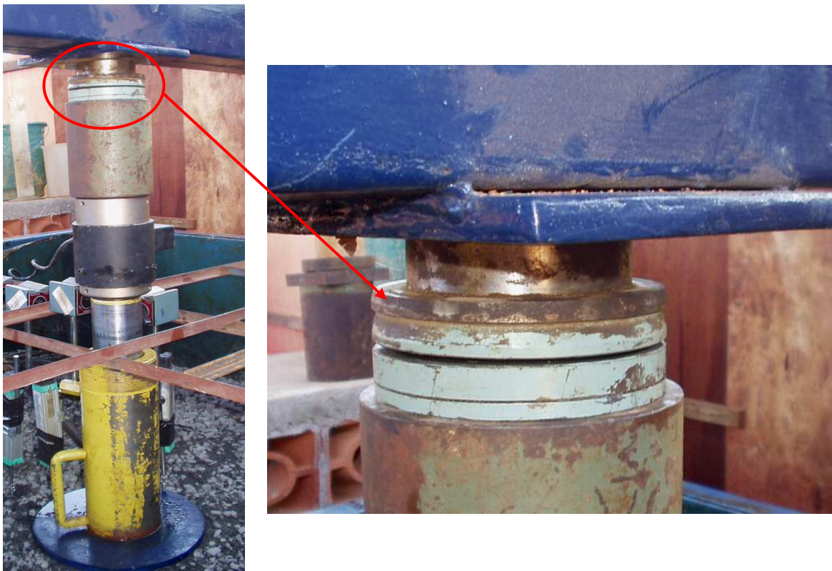
Figura 5.19 – Conjunto de aplicação de cargas e detalhe da rótula utilizada.
