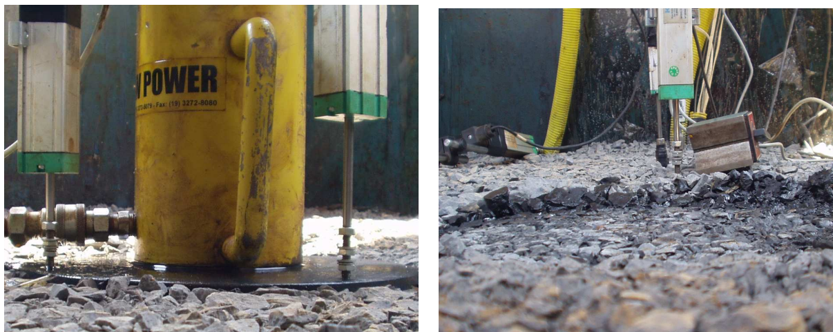
Figura 5.22 – Recalque superficial no momento em que o ensaio foi finalizado.
