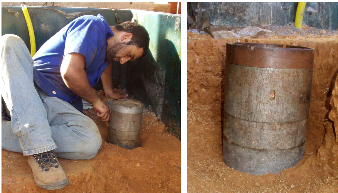
Figura 5.26 – Retirada dos corpos de prova para execução de ensaios de CBR
