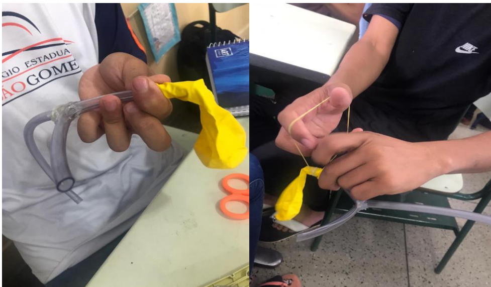
Figura 14- Aluno prendendo bexigas nas extremidades da mangueira com elástico. Fonte: própria.
