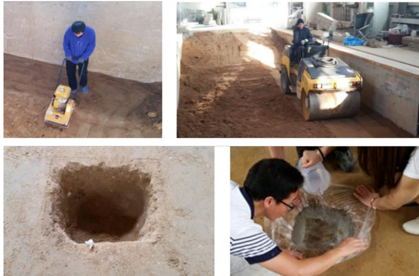
Figura A.2: Aplicação de sobrecarga com aterro compactado e controle do peso específico do material (Lee et al., 2017)
