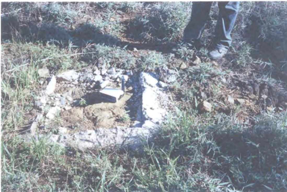
Foto 4.2 – Aquisição das coordenadas da estação digital NP9, com uso de GPS disposto nos resquícios do abrigo dos sismômetros instalados em afloramento de basalto.
