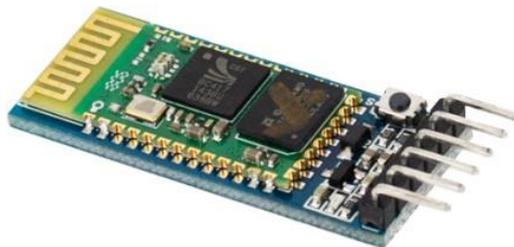
Figura 3.21: Módulo Bluetooth HC-05. Fonte: Site Baú da Eletrônica.
