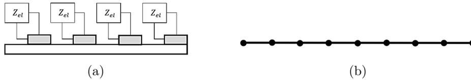
Figura 3.1 – Elemento *smart material*: a) modelo físico; b) modelo elemento espectral.
