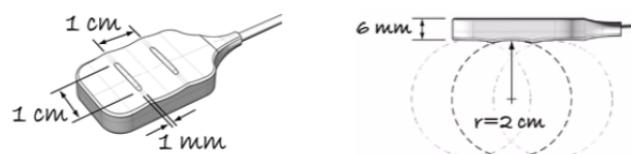
Figura 15 – Dimensões e geometria do eletrodo do Delsys Bagnoli-2. Adaptado de DELSYS [38].
