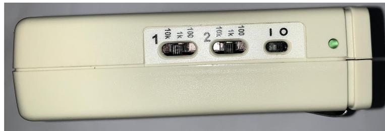
Figura 14 – Ajustes de ganho e chave liga/desliga do Delsys Bagnoli-2.
