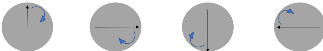
Figura I.02. Relaxamento de Néel. O momento magnético se move no interior da partícula.
