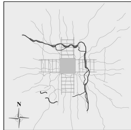
Figura 4.112 – Mapa de fissuração da laje FA-05
