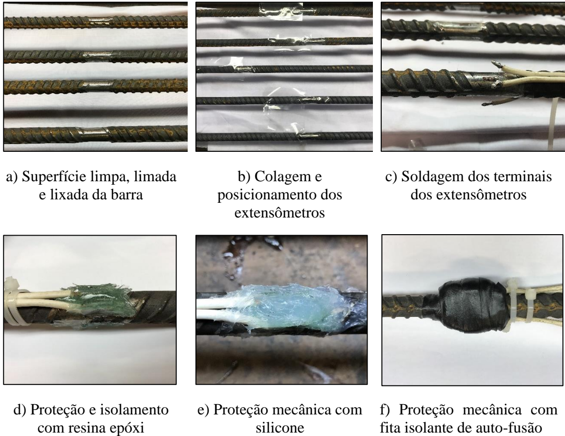
Figura 3.43 - Procedimento de colagem dos extensômetros
