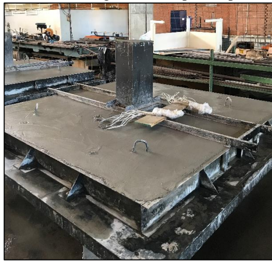
b) Moldagem dos corpos de prova
