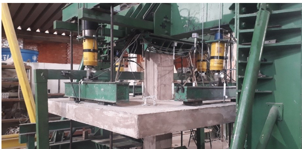
Figura 3.21 - Sistema de ensaio: laje CCA pronta para o ensaio
