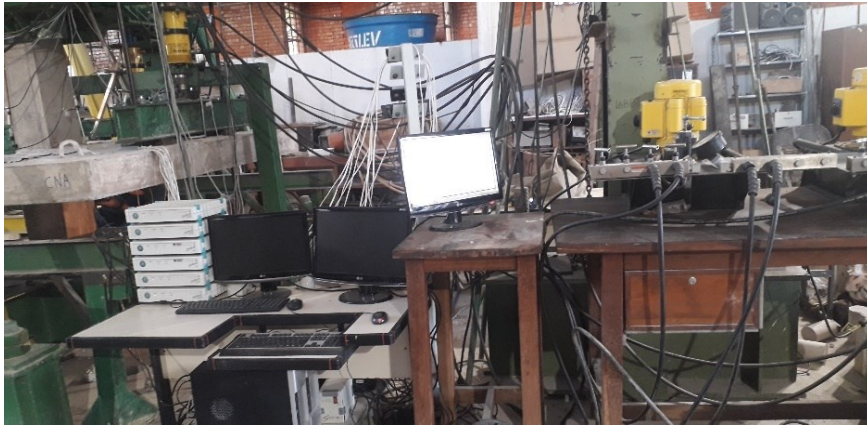
Figura 3.22 - Bombas hidráulicas para aplicação da carga e sistema de aquisição de dados montado para o ensaio da laje CNA
