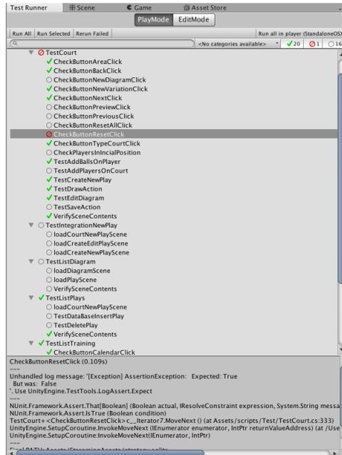
Figura 16 – Tela principal da ferramenta *Test Runner* com a lista de testes por classe. Os itens marcados em vermelho indicam que o teste falhou. A parte inferior indica, entre outras informações, a linha exata onde a falha aconteceu.
