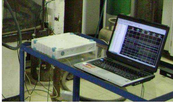
A Figura 3.9. Sistema de aquisição de dados (Spider).
