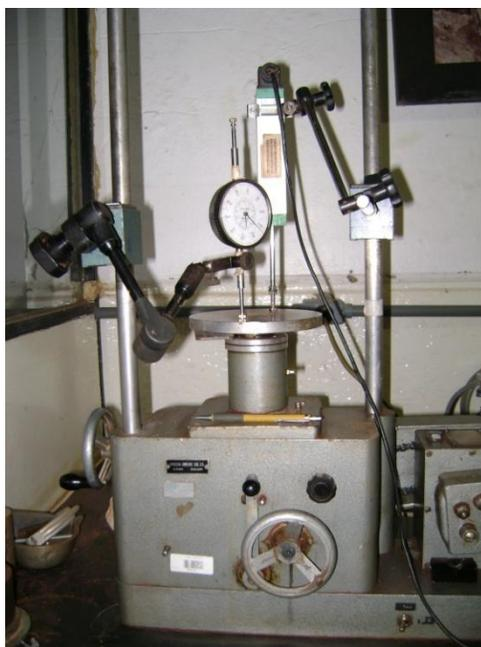
Figura 3.14. Calibração do transdutor de deslocamento.
