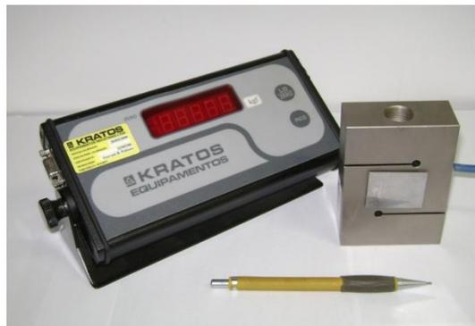
Figura 3.10. Célula de carga e leitora digital.
