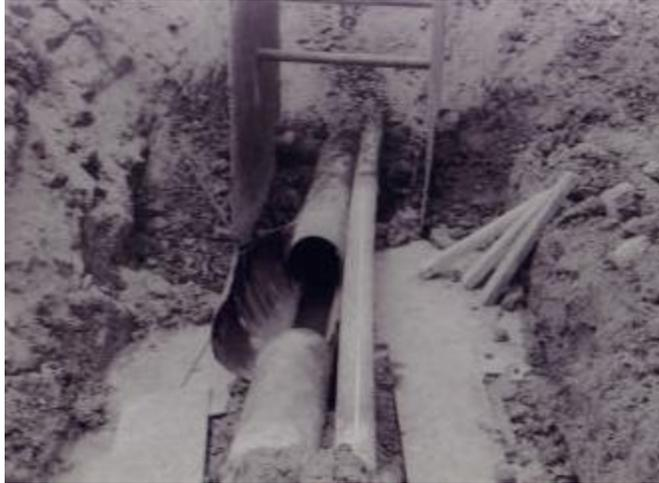
Figura 2.6. Ruptura de tubulação de gás natural (National Transportation Safety Board, 1999).
