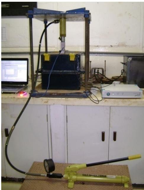
Figura 3.12. Calibração das células de tensão total.
