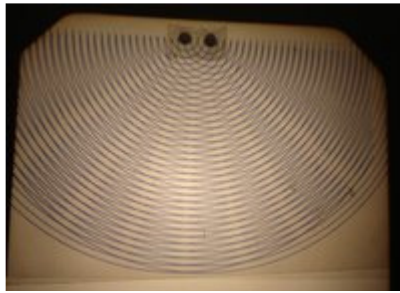
Figura 4 – Simulação de um padrão de interferência em lâminas para retroprojeter. Internet: < davinci.if.ufrgs.br/wiki/index.php/Ondas >.
