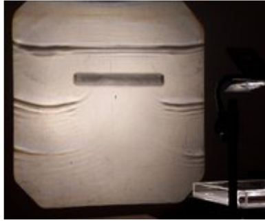
Figura 5 – Difração em barreira na cuba de ondas.
