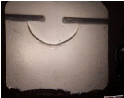
Figura 6 – Difração por fenda na cuba de ondas.
