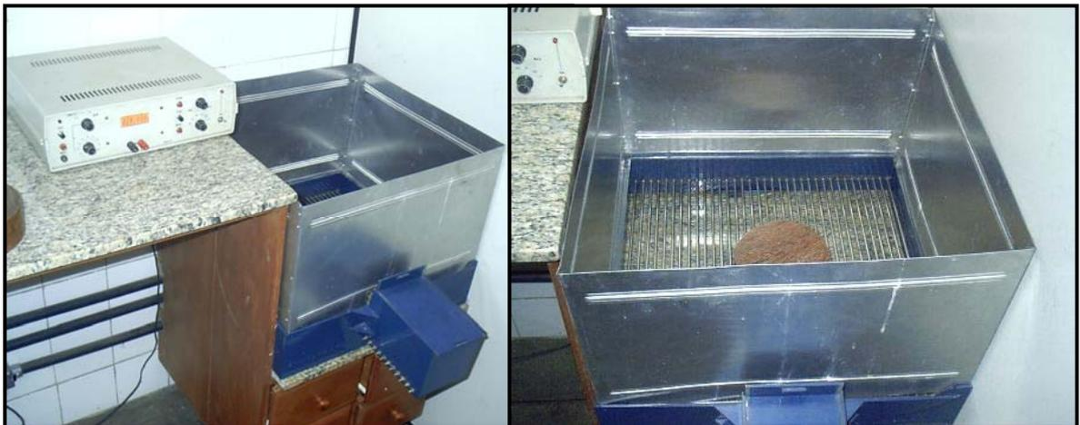
**Figura 6 - Teste da esquiva inibitória** – À esquerda, a vista lateral do equipamento e o sensor de controle do tempo e da intensidade do choque; À direita (vista superior), a plataforma de madeira sobre as grades de ferro.
