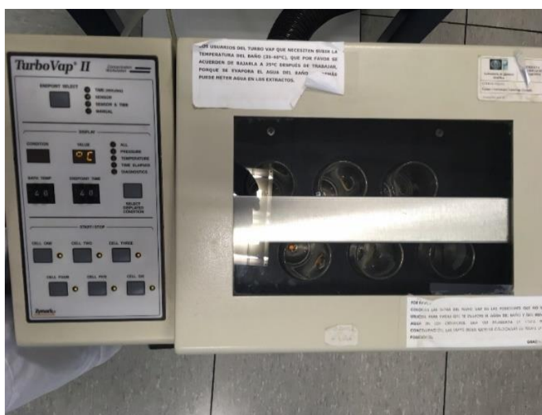
Figura 15. Amostras sendo concentradas no aparelho TurboVap® à 40 °C e com fluxo de N 2 .
