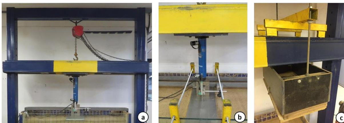
Figura 3. 3. Viga de reação – (a) vista frontal da viga; (b) detalhe do encaixe do sistema de aplicação de carga à viga; (c) sistema de pulverização de areia acoplada na parte superior.
