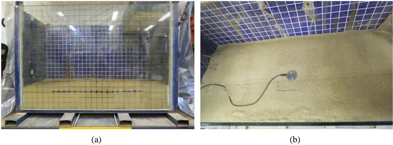
Figura 4. 13. Montagem do ensaio não reforçado – (a) primeiras camadas; (b) posicionamento da C1.
