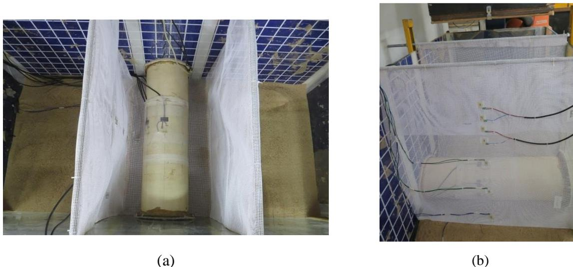
Figura 4. 19. Fixação do reforço GG4 no ensaio com arranjo envelopado.
