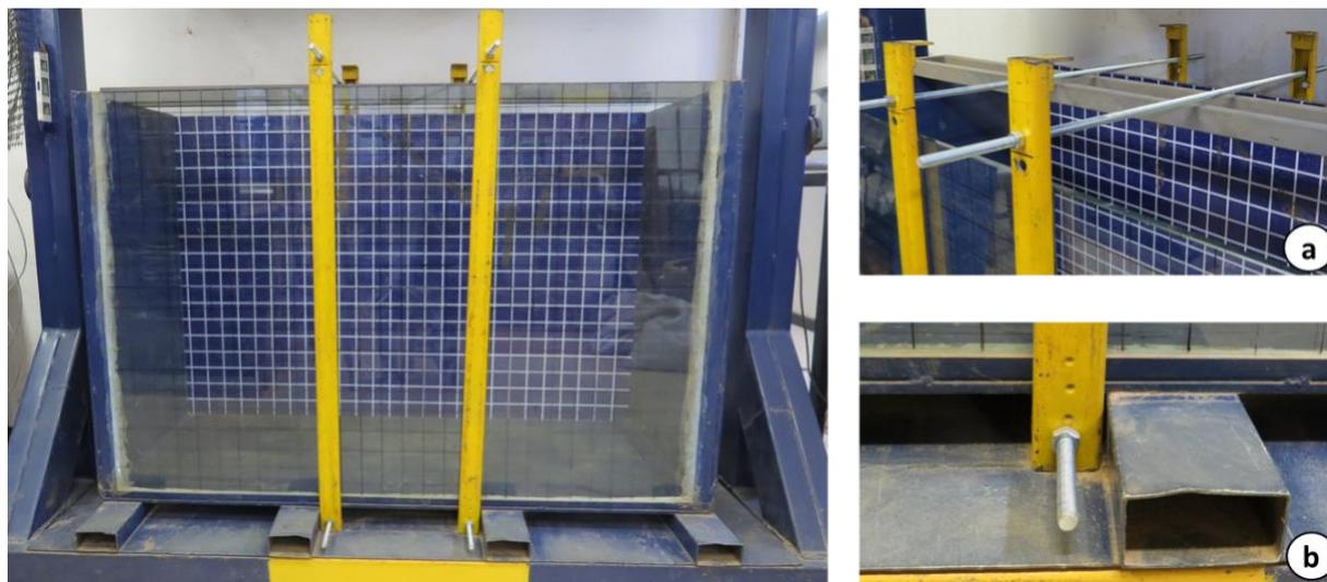
Figura 3. 4. Caixa de ensaio e sistema de travamento – (a) travamento na parte superior; (b) detalhe do travamento inferior.
