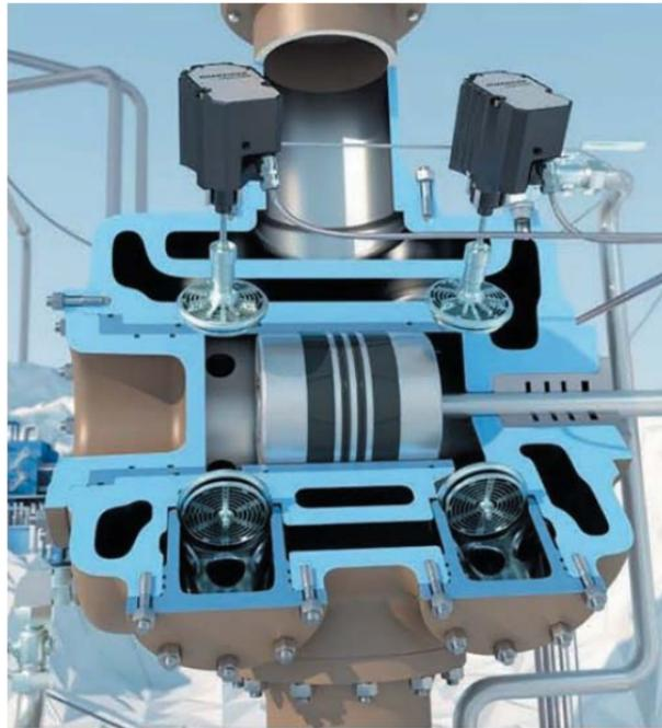
Figura 3.12 – Cilindro de duplo-efeito. Adaptado de (BORREMANS, 2019).
