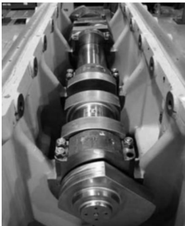
Figura 3.9 – Virabrequim de um compressor feito de aço SAE 4140 tratado termicamente e forjado. Adaptado de (GIAMPAOLO, 2010).
