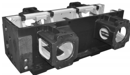
Figura 3.8 – Cárter. Adaptado de (STEWART, 2018).
