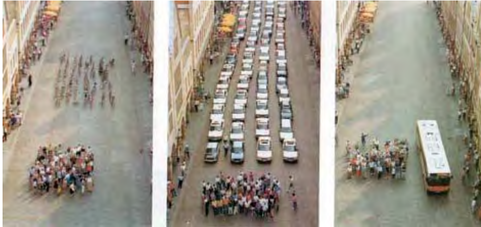
Figura 2.7: Espaço ocupado por 72 pessoas em cada modo de transporte. Fonte: City of Muenster (2009)
