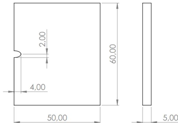
Figura 7.8 – Dimensões da geometria com furo lateral elipsoide
