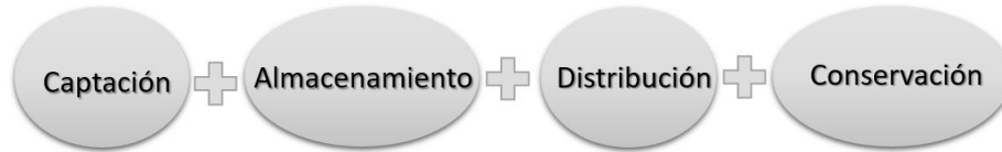
Figura 2: Principios del calentamiento solar pasivo
