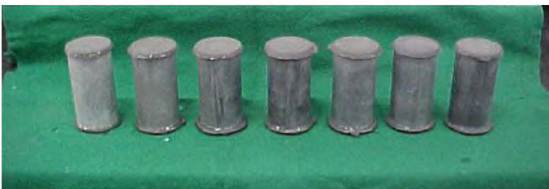
Figura 5. 100 - Corpos de Prova de argamassa com relação a/agl = 0,50 para os 7 (sete) aglomerantes analisados. Da esquerda para a direita: (1) 100% CP I; (2) 5% CCA amorfa; (3) 10% CCA amorfa; (4) 20% CCA amorfa; (5) 5% CCA cristalina; (6) 10% CCA cristalina; (7) 20% CCA cristalina.
