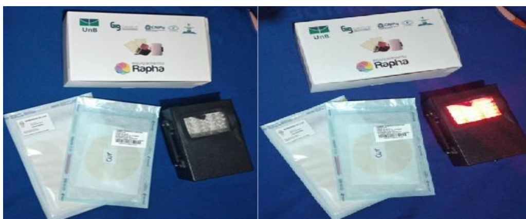
Figura 4.1.5.1. Dispositivo terapêutico Rapha® emissor de luz de LEDs do sistema terapêutico Rapha®. (1) Dispositivo Rapha® desligado, (2) ligado onda vermelha ( 636 \pm 20 nm). Fonte: própria autora.
