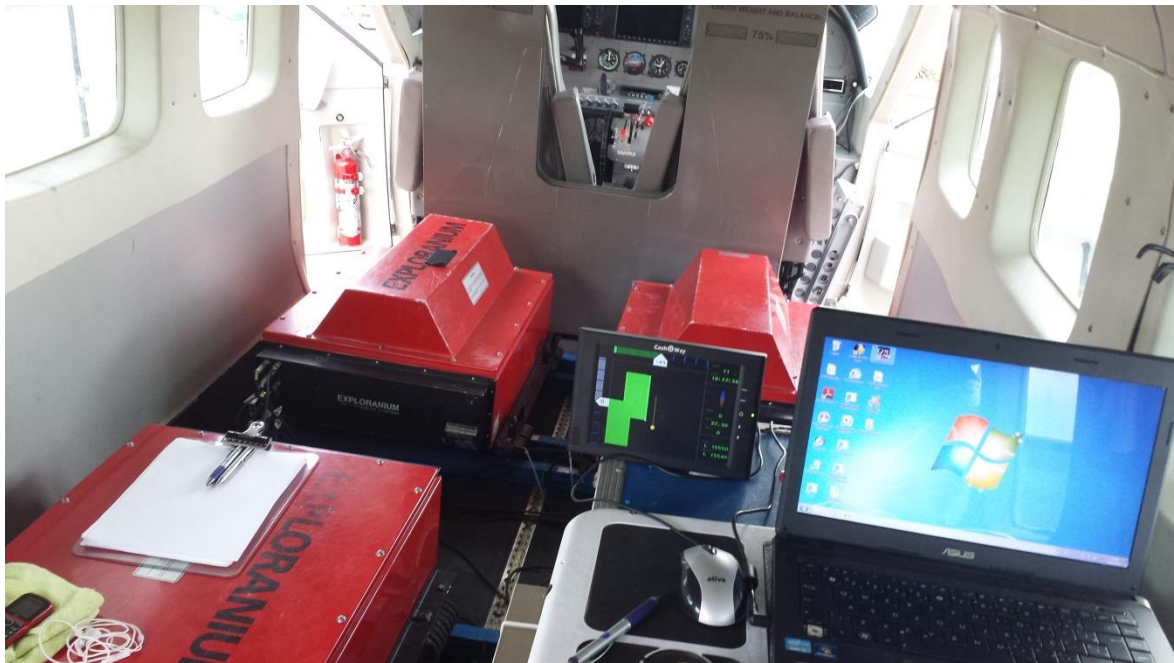
Figura 1.4 – Sistema de aquisição de dados radiométricos montado a bordo de uma das aeronaves utilizadas nos aerolevantamentos. Em evidência o gamaespectrômetro digital da marca EXPLORANIUM, modelo GR-820. As caixas vermelhas, detectores downward e upward , contêm os cristais de iodeto de sódio dopado com Tálcio (NaI(Tl)).
