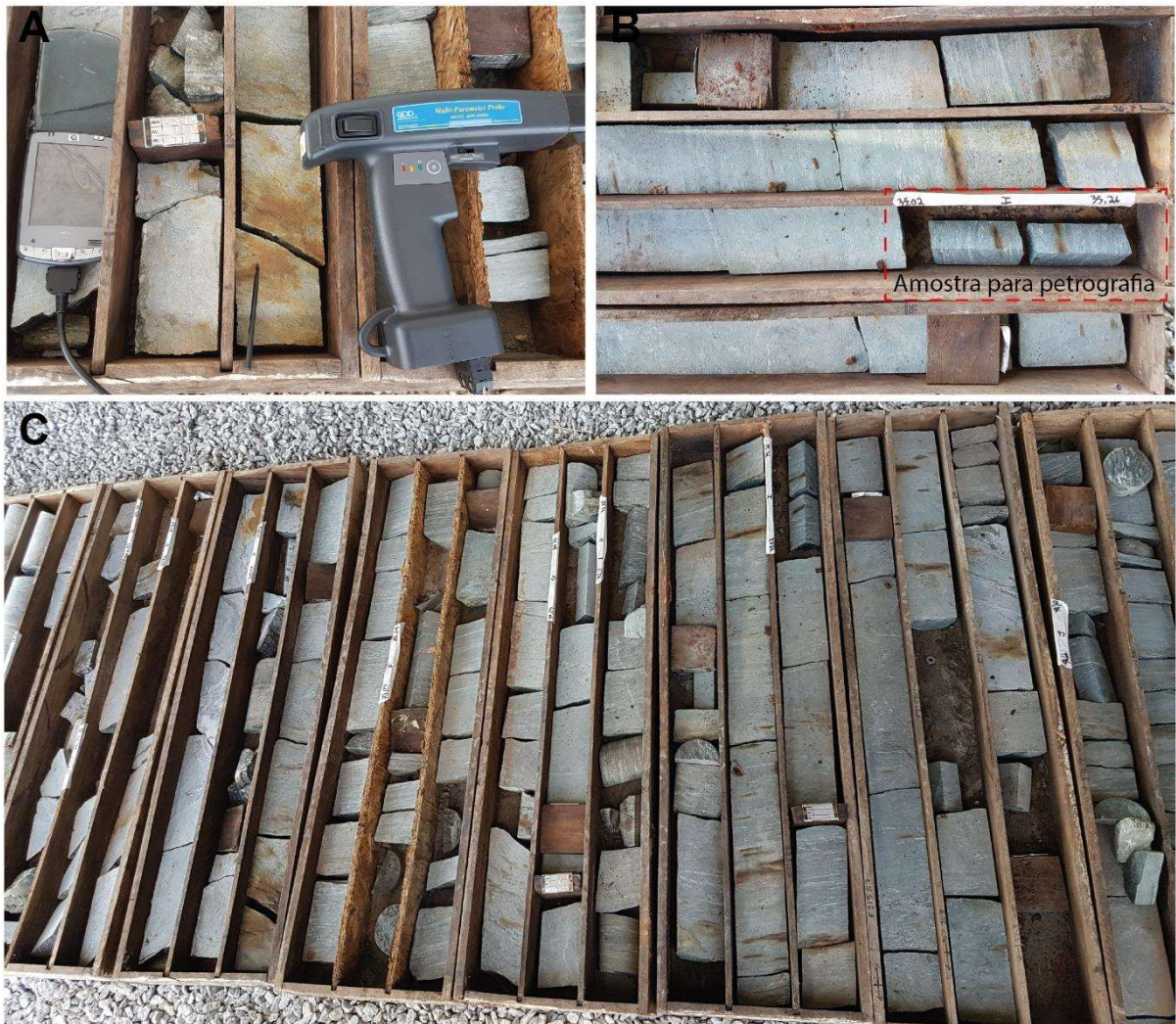
Figura 3.2- (a) Susceptibilímetro magnético modelo MPP-EM2S+ (GDD Instrumentation). Testemunho de sondagem GDD-001: (b) Nível de 0.20cm amostrado para petrografia e (c) Testemunho de sondagem GDD-001 com níveis variáveis de preservação.
