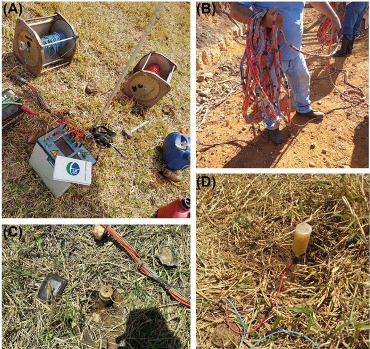
Figura 5.5 - (a) Resistivímetro multi-eletródico modelo SYSCAL PRO 72, conectado aos eletrodos de injeção de corrente e de potencial; (b) Cabos utilizados na aquisição de dados de cargabilidade; (c) Eletrodo de potencial de PVC, conectado a cabo; (d) Eletrodo de injeção de corrente (aço inox).
