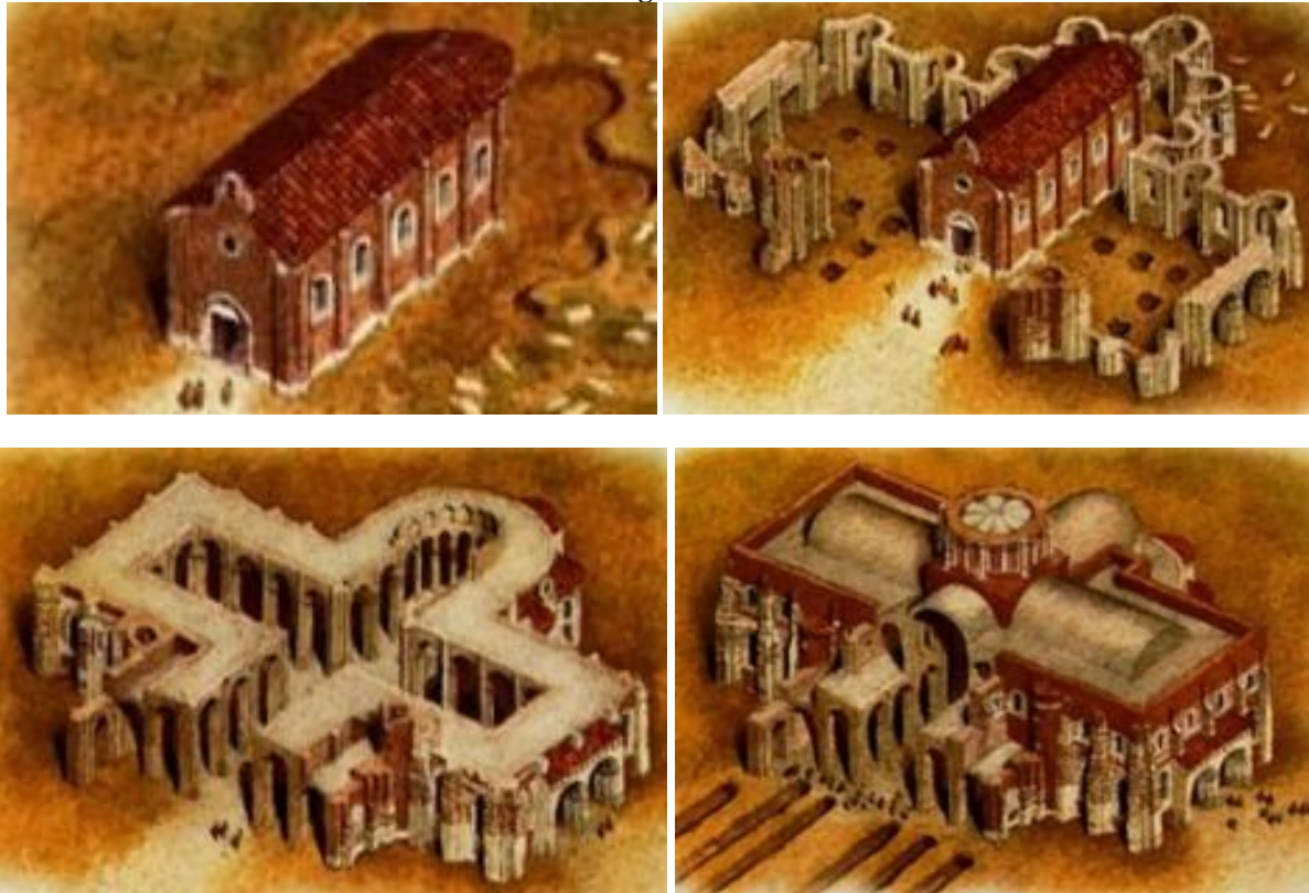
(Processo construtivo. Representação esquemática. Basílica Saint-Sernin, Toulouse, França) 243
