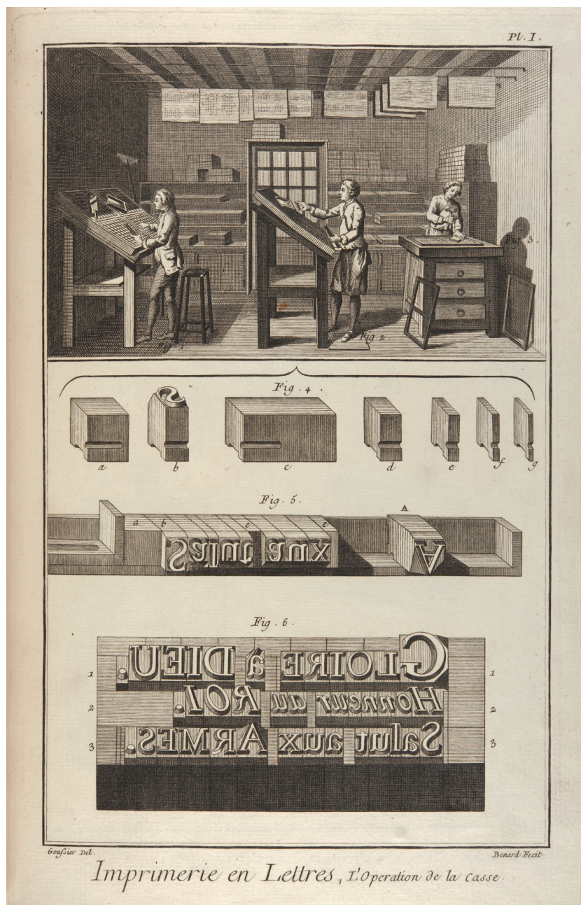
Figura 96: Na parte inferior da gravura é possível ver os tipos e espaços em perspectiva isométrica (Fig.4), o componedor (Fig.5) e um bloco justificado (Fig.6).Fonte: GOUSSIER, c.1700.
