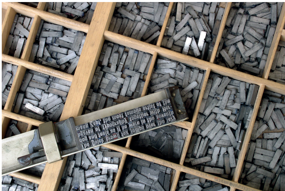
Figura 26: Gaveta de tipos móveis e componedor. Fonte: HEIDELBACH, 2004
