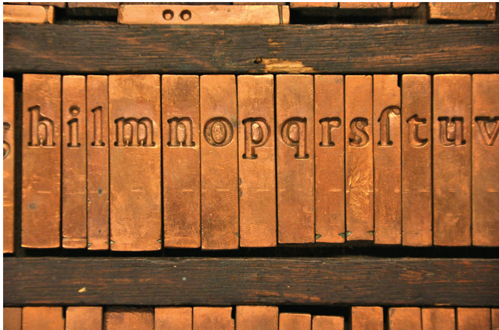
Figura 93: Matrizes originais de Claude Garamond, século XVI. Fotografado no Museu Plantin-Moretus, Antuérpia, em março de 2012. Fonte: do autor.
