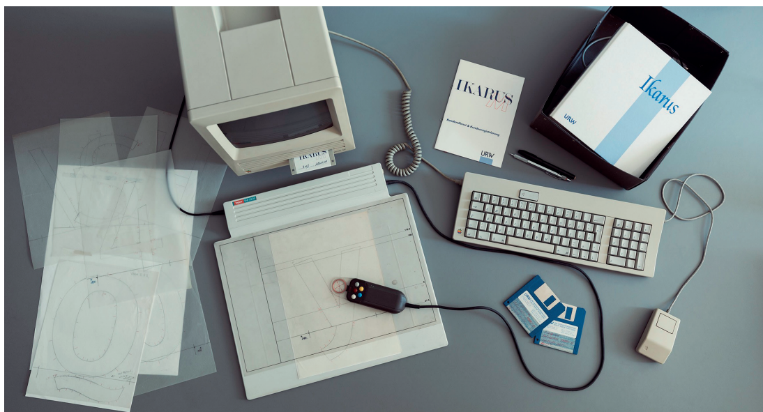
Figura 31: Mesa de trabalho de um designer de tipos do final dos anos 1980. Computador Apple Macintosh, software Ikarus M, teclado, mouse e desenhos de letras para digitalização na mesa digitalizadora Aristo. Materiais da coleção de Erik Spiekermann, fotografados por Norman Posselt, Berlin. Fonte: POSSELT, 2018.
