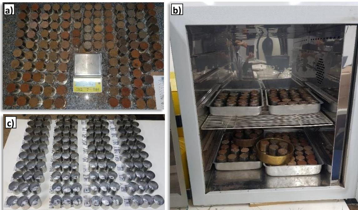
**Figura 5.4.** Amostras indeformadas de solo para estimativa de umidade: (a) solo úmido; (b) amostras secas na estufa e (c) anéis limpos prontos para reutilização.
