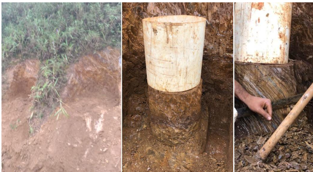
Figura 4.17. Retirada de blocos indeformados para a realização de ensaios de laboratório.
