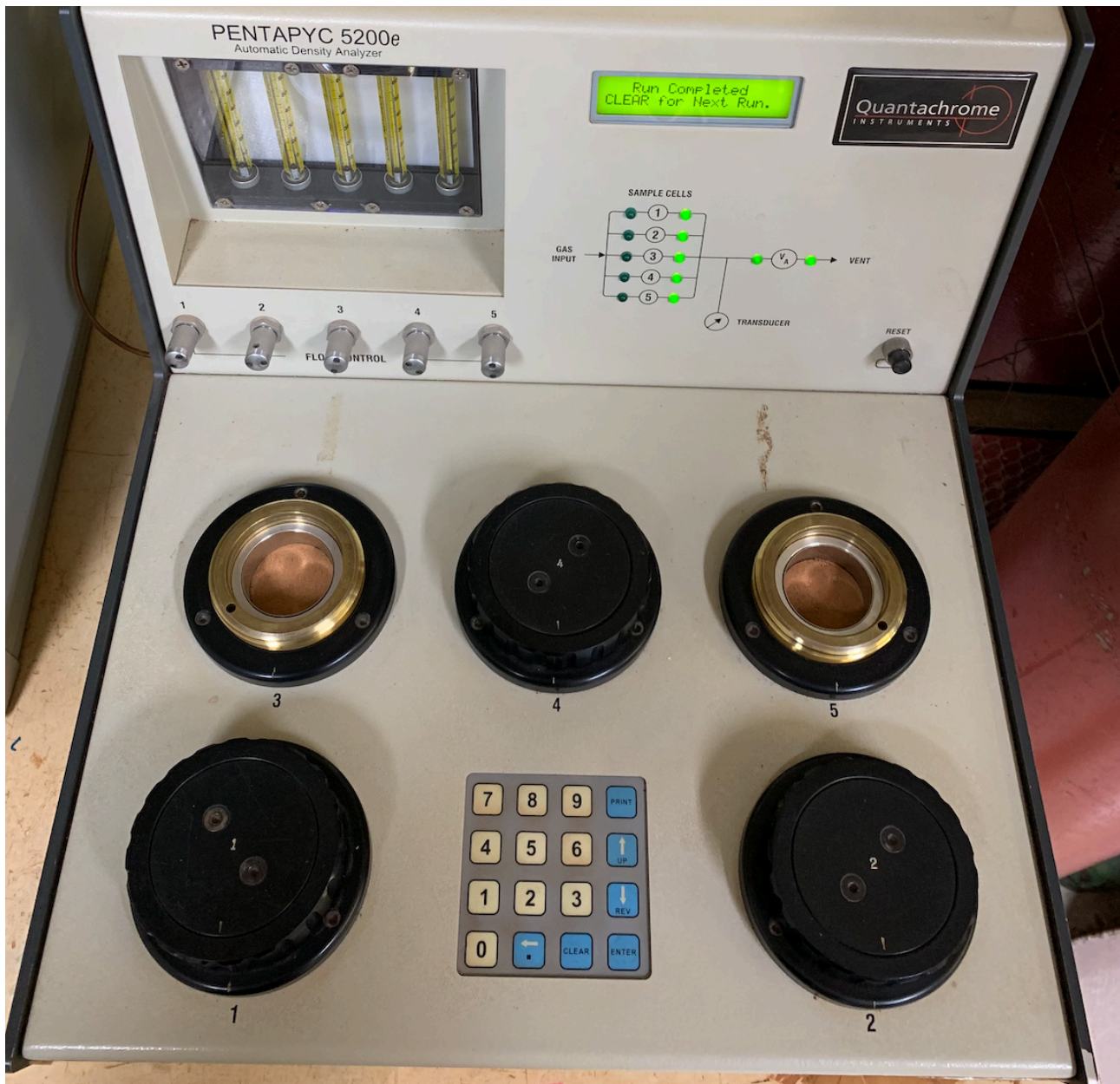
Figura 8: Pentapyc 5200e, equipamento utilizado na coleta da densidade absoluta do material friável dos níveis saprolíticos encontrados nos testemunhos de sondagem utilizados nessa pesquisa.
