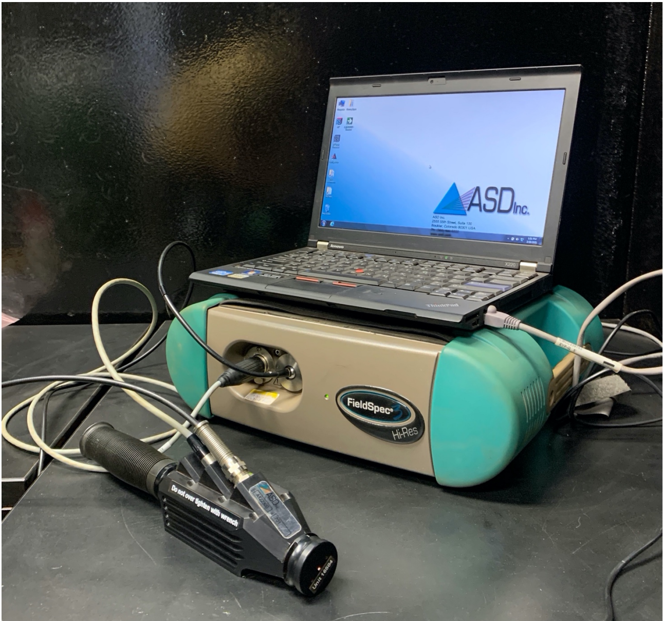
Figura 5: O espectrorradiômetro de reflectância FieldSpec3HiRes (ASD) utilizado neste trabalho na coleta de dados espectrais.
