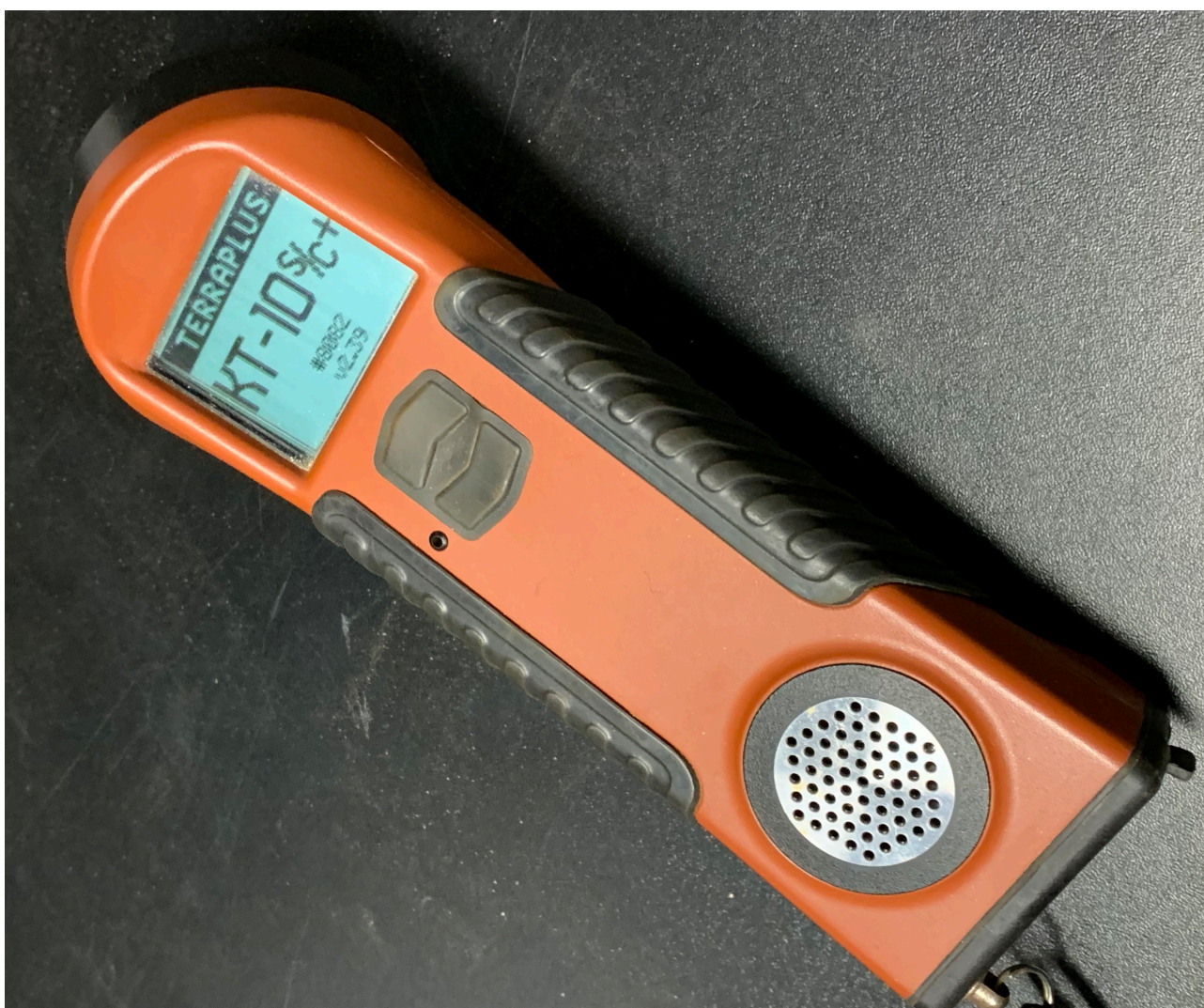
Figura 10: Fotografia do susceptibilímetro portátil da Terra Plus modelo KT-10S/C+, utilizado neste trabalho.
