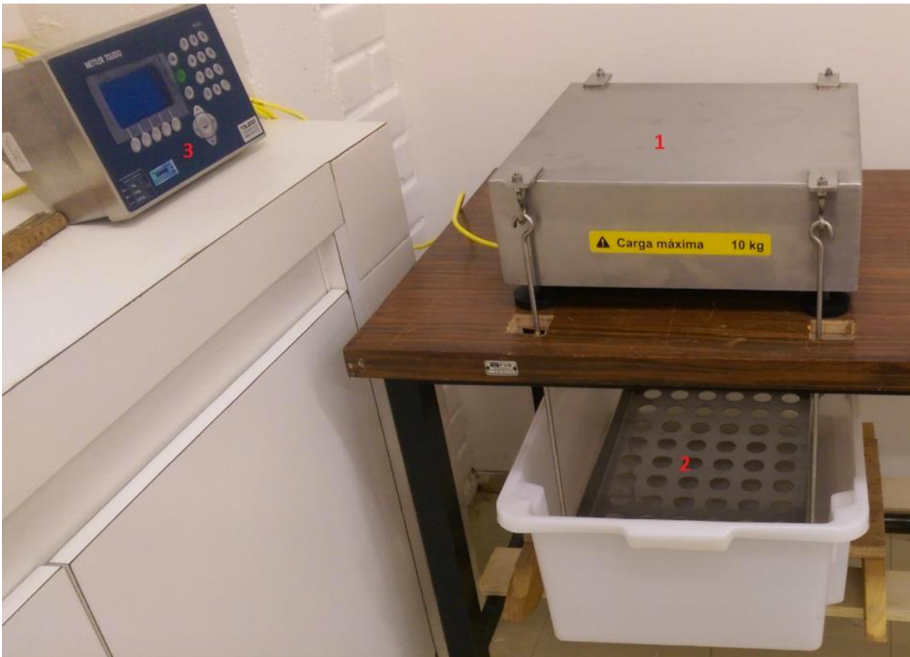
Figura 7: Balança Toledo - IND560 usada para a realização do trabalho. 1-Base a seco; 2-Base submersa; 3- Painel de visualização dos valores da massa do corpo em questão.
